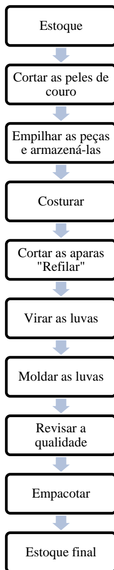
Figura 5.4 - Fluxograma geral do processo de fabricação de luva.
