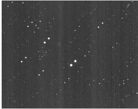
Figura 5.8: Imagem obtida com o analisador da estrela HD126593 no centro. O feixe ordinário está em baixo e o extraordinário em cima.
