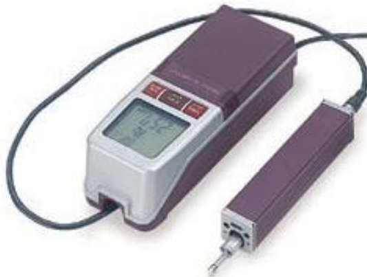
Figura 5.13 – Rugosímetro utilizado na leitura das medições.
