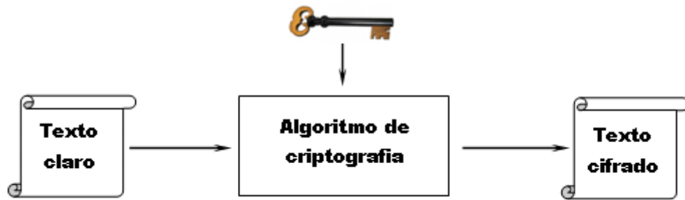
Figura 2.3: Esquema geral de criptografia com chave.
