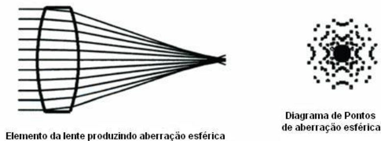
Figura 3.1: Diagrama de pontos criado por uma lente simples mostrando aberração esférica.
