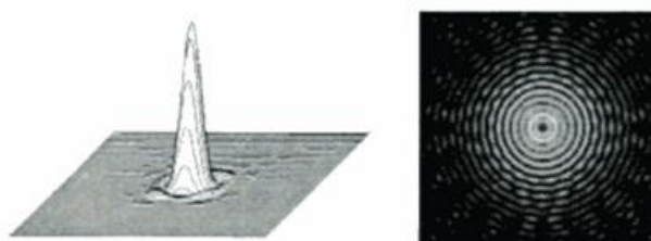
Figura 3.2: Função de alargamento de pontos (PSF) para um sistema livre de aberração.
