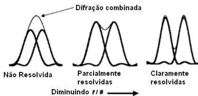
Figura 3.8: Intensidades combinadas para dois pontos em função de f -number.
