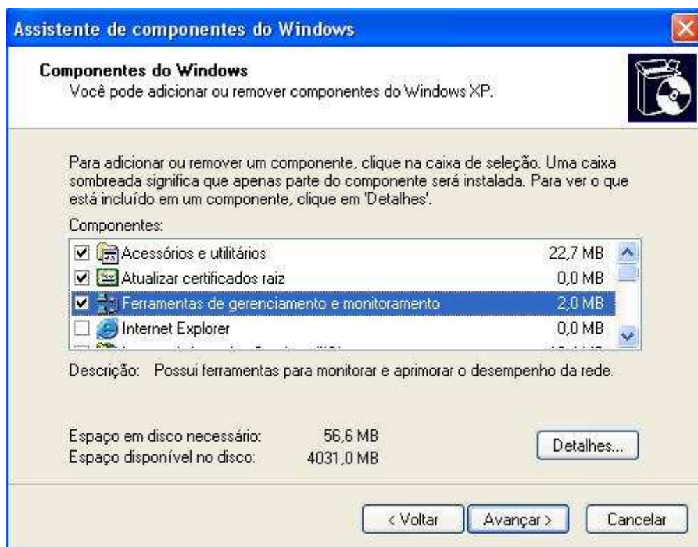
Figura 16 - Instalação do SNMP da Microsoft
