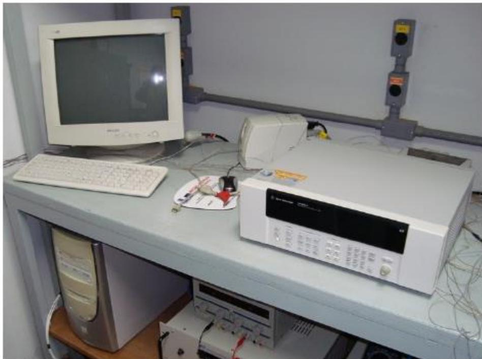
Figura 5.8 – Equipamento de aquisição de dados Agilent.
