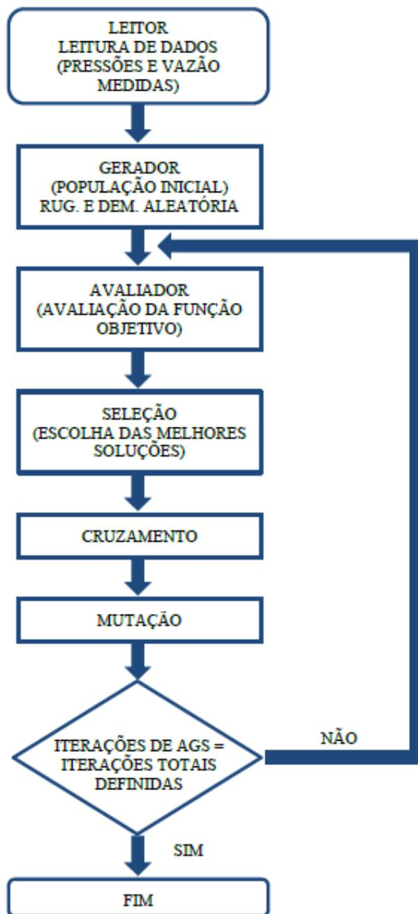
Figura 56 – Fluxograma do AG empregando o Modelo implementado com demanda aleatória.
