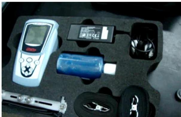
Figura 26 – Maleta do equipamento ultrassom e seus acessórios.
