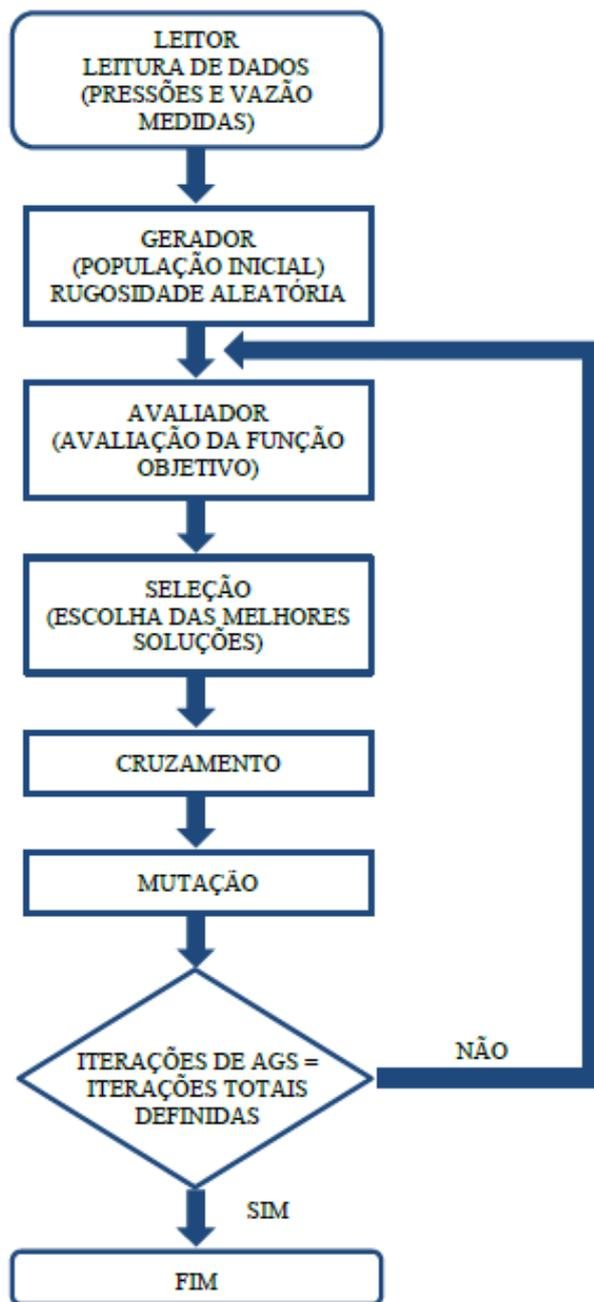
Figura 55 – Fluxograma do AG empregando o modelo proposto por SILVA (2003).
