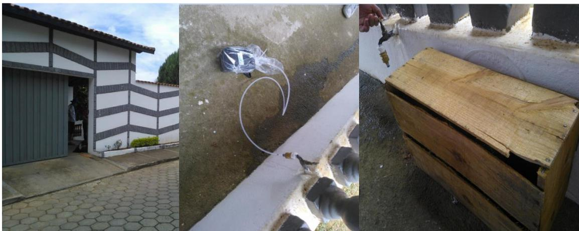
Figura 37 – Foto do medidor de pressão, data logger, instalado em uma das residências no bairro Vila Mariana.
