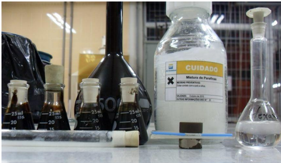
Figura 6. Amostras de petróleo confinadas em Erlenmeyers, parafinas e placa de acrílico entre dois ímãs (Nd-Fe-B).
