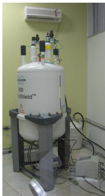
Figura 9. Espectrômetro de RMN Bruker Avance III 500. Cortesia de Profa. Dra. Gláucia Braz de Alcantara – IQ/Universidade Federal de Goiás.
