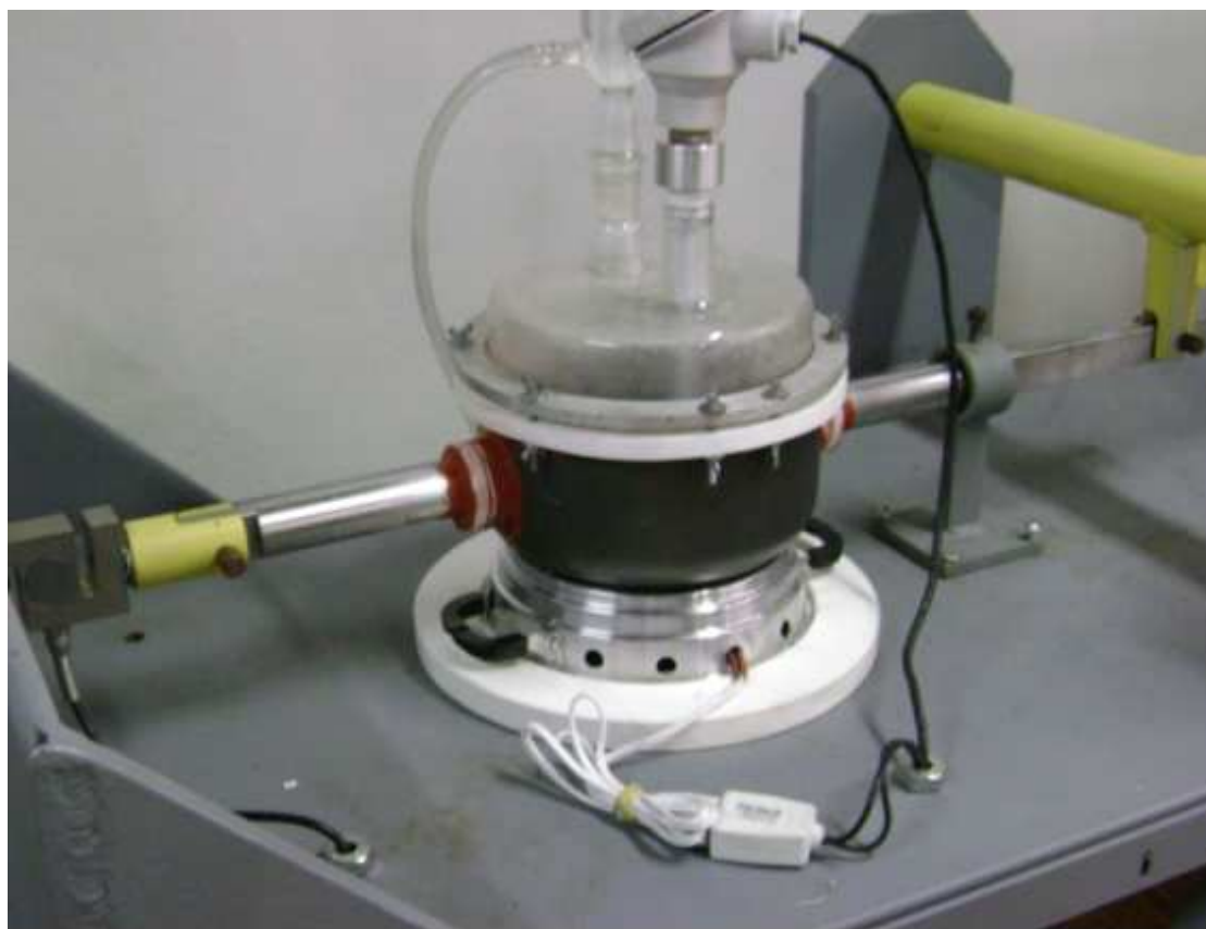
Figura 76 - Sistema de fechamento vertical com cuba revestida de Teflon.
