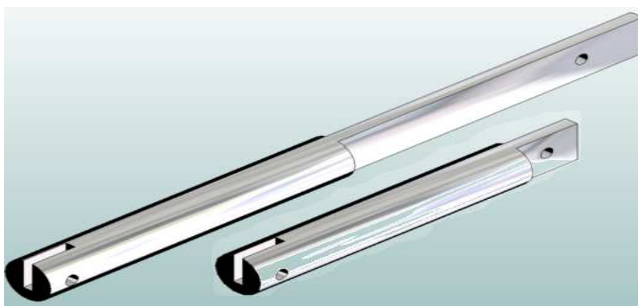
Figura 20 - Garras do sistema de tração dos corpos de provas.
