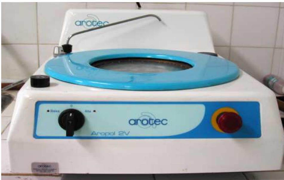
Figura 41 - Politriz arotec utilizada no polimento das amostras, LMM da UNIFEI.
