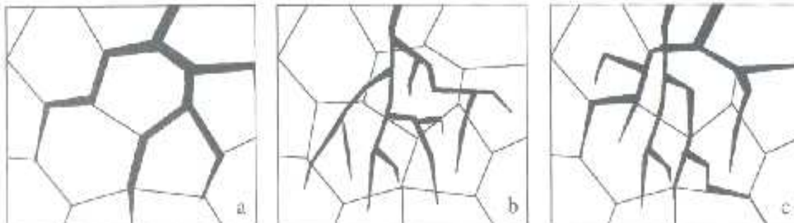
Figura 1 - Trincamento por corrosão sob tensão: (a) trincas intergranulares, (b) trincas transgranulares, (c) trincas mistas, transgranulares e intergranulares (GEMELLI, E., 2001).
