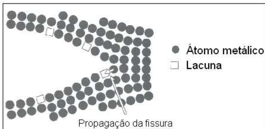
Figura 5 - Figura esquemática mostrando a difusão de lacunas para a ponta da fissura de um material metálico (GEMELLI, E., 2001).
