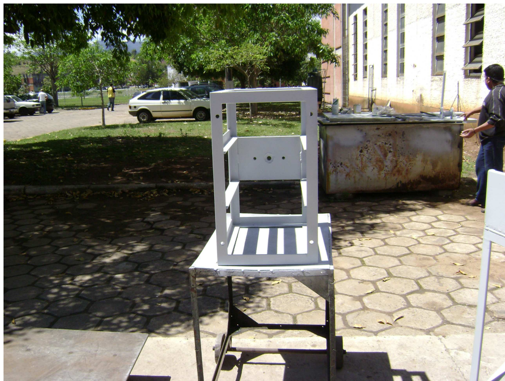
Figura 78 - Painel de Montagem do aplicador de força e instrumentação.
