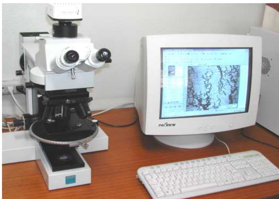
Figura 42 - Microscópio óptico JENAVERT (2000x) e Analisador de imagens OLYMPUS, modelo U-TVO.5XC-3, do laboratório de metalurgia e materiais da UNIFEI.
