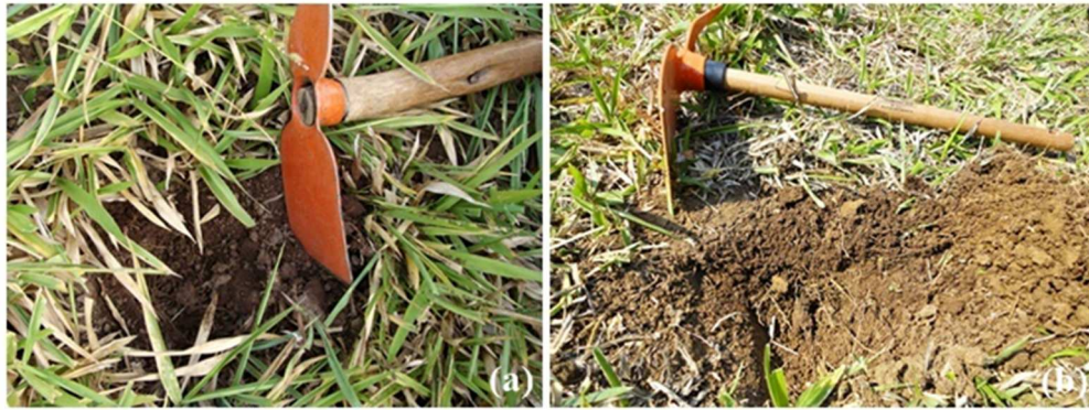
Figura 4. 7 Limpeza da camada superficial do solo (a) Detalhe da retirada da amostra; (b) Vista geral da amostra retirada para início da aplicação da metodologia de avaliação visual da qualidade do solo
