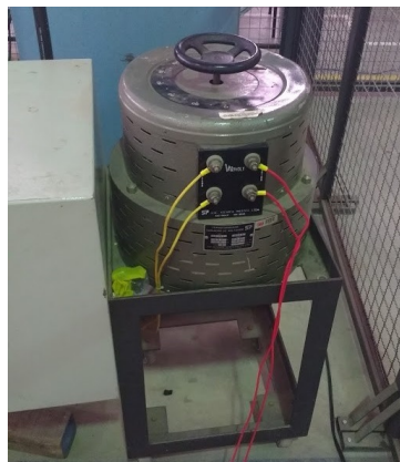
Figura 11 – VARIAC utilizado para a indução de corrente
