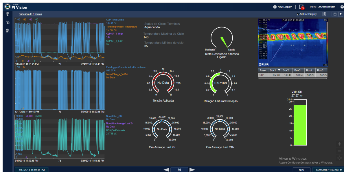
Figura 76 – Dashboard web no PI Vision para monitoramento remoto de ensaio de ciclos térmicos
