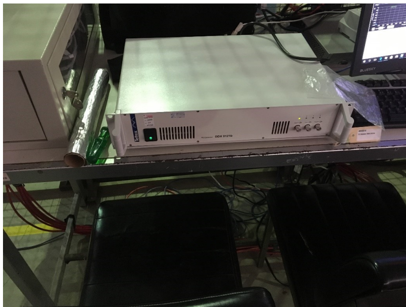
Figura 14 – Medidor de descargas parciais instalado na bancada
