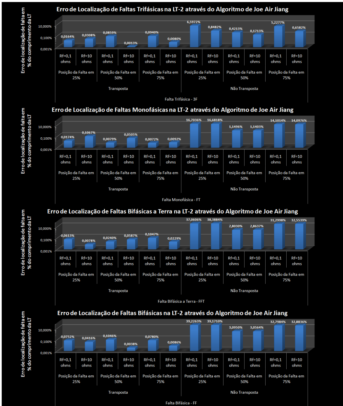
Figura 6.2 – Erro de Localização de Falta à 25%, 50% e 75% da LT em % do comprimento da LT para a LT-2 modelada na condição transposta e não transposta
