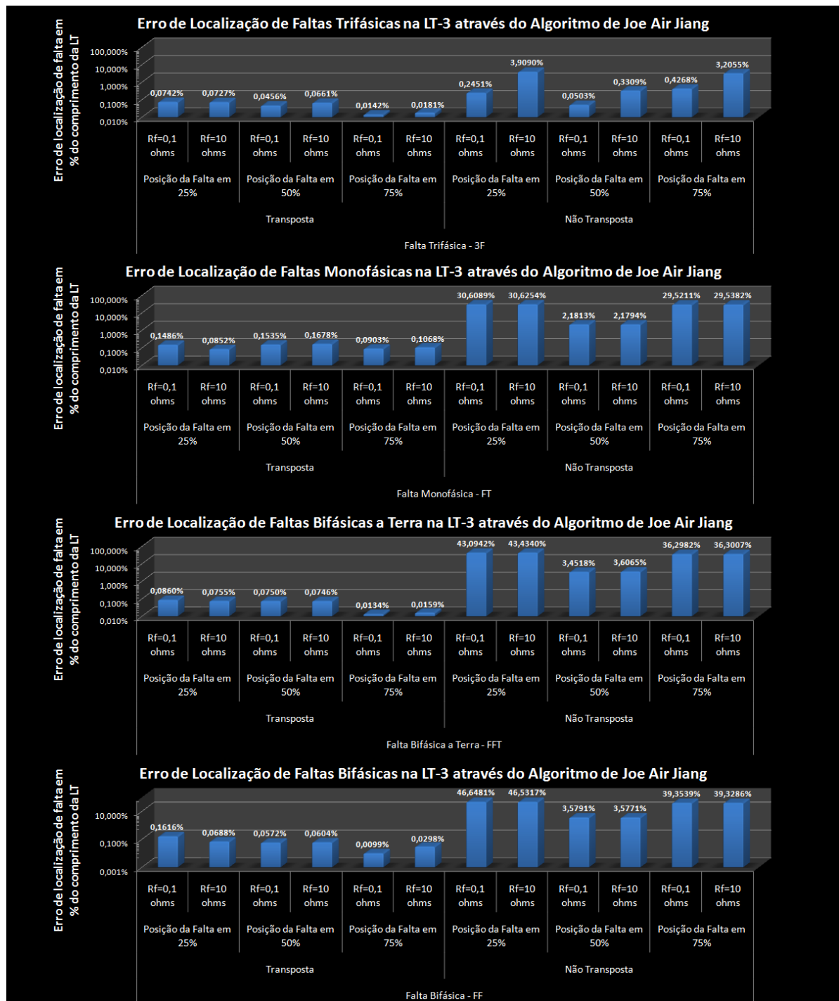
Figura 6.3 – Erro de Localização de Falta à 25%, 50% e 75% da LT em % do comprimento da LT para a LT-3 modelada na condição transposta e não transposta
