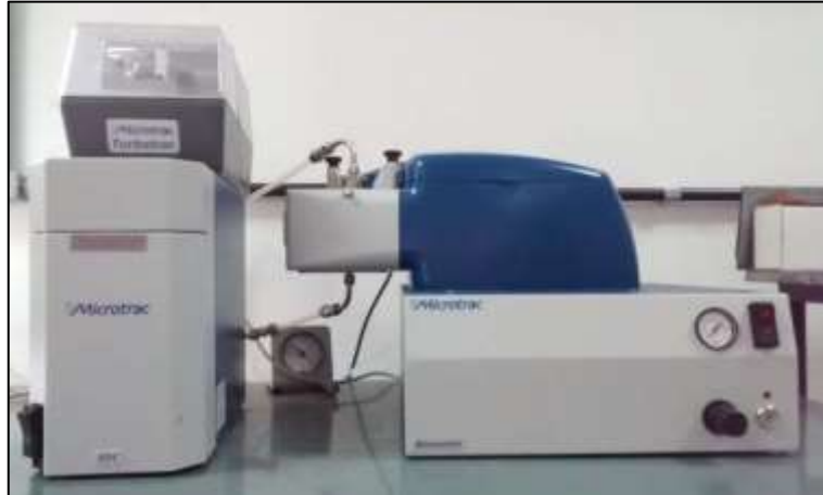
Figura 3.3: Analisador de tamanho de partículas Microtrac, S3500.
