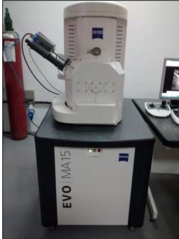
Figura 3.4: Microscópio eletrônico de varredura da marca Zeiss, modelo EVO MA15.
