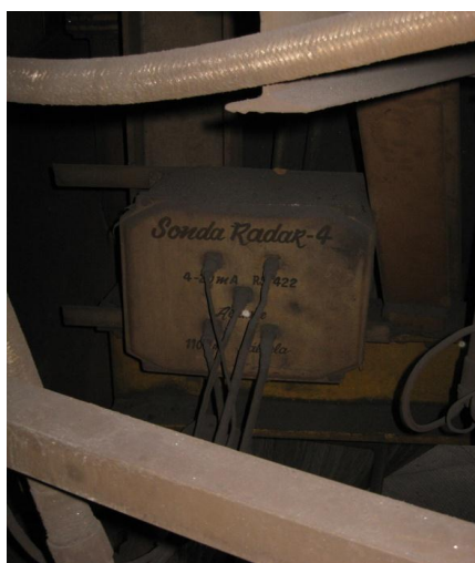
Figura 2.2 - Medida de nível da quantidade de carga do vagão torpedo verificado na Companhia Siderúrgica Nacional.
