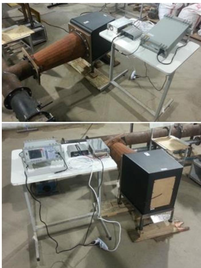
Figura 113: Configuração final do SA utilizada no teste com intensificação acústica
