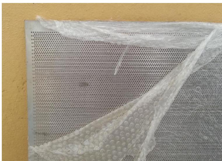
Figura 93: Chapa utilizada para a fabricação da grelha.
