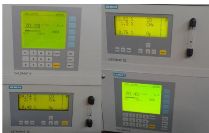
Figura 73: Analisadores contínuos de gases.
