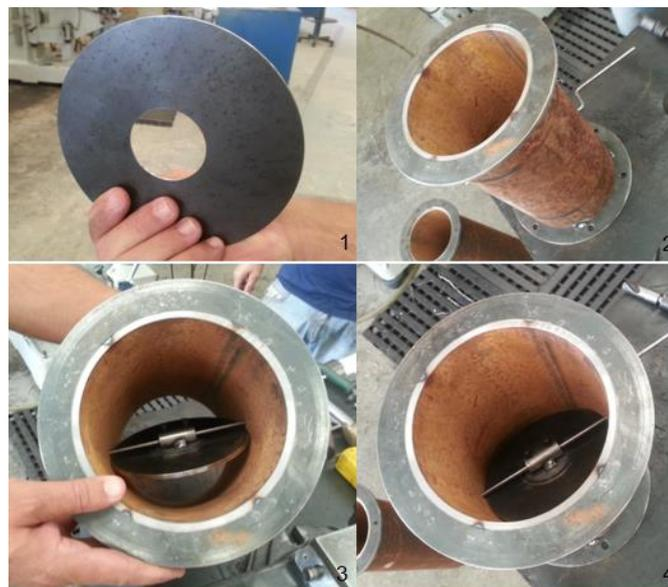
Figura 132: Processo de usinagem do damper corta fogo na GNS Usinagem.
