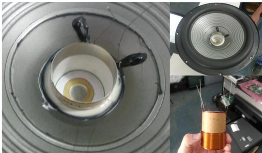
Figura 110: Autofalante queimado em recondicionamento e bobina substituta.
