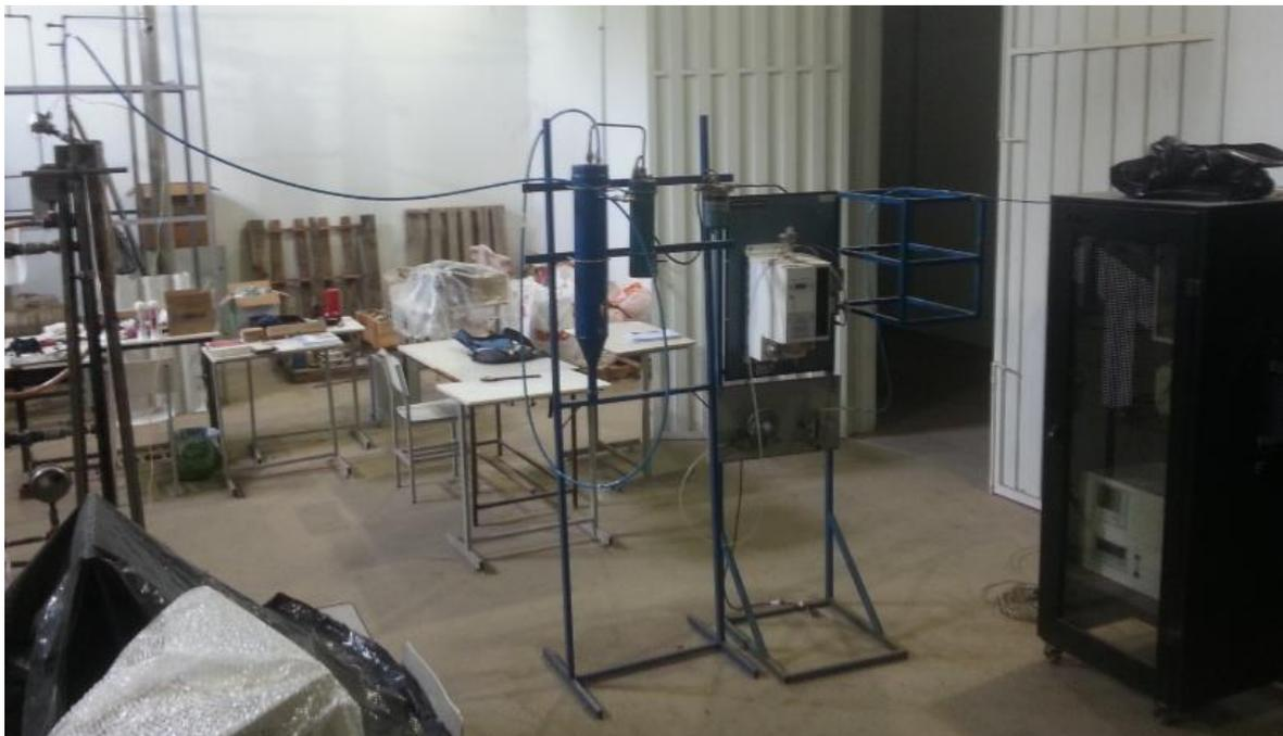
Figura 109: Sistema completo de análise de gases de combustão do leito.
