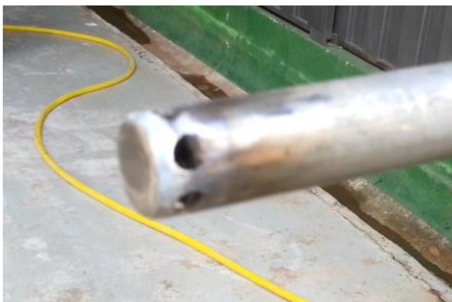
Figura 103: Extremidade inferior da sonda: acessos para amostra de gases.
