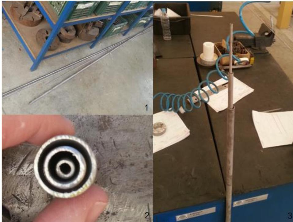
Figura 97: Tubulação e montagem da sonda.
