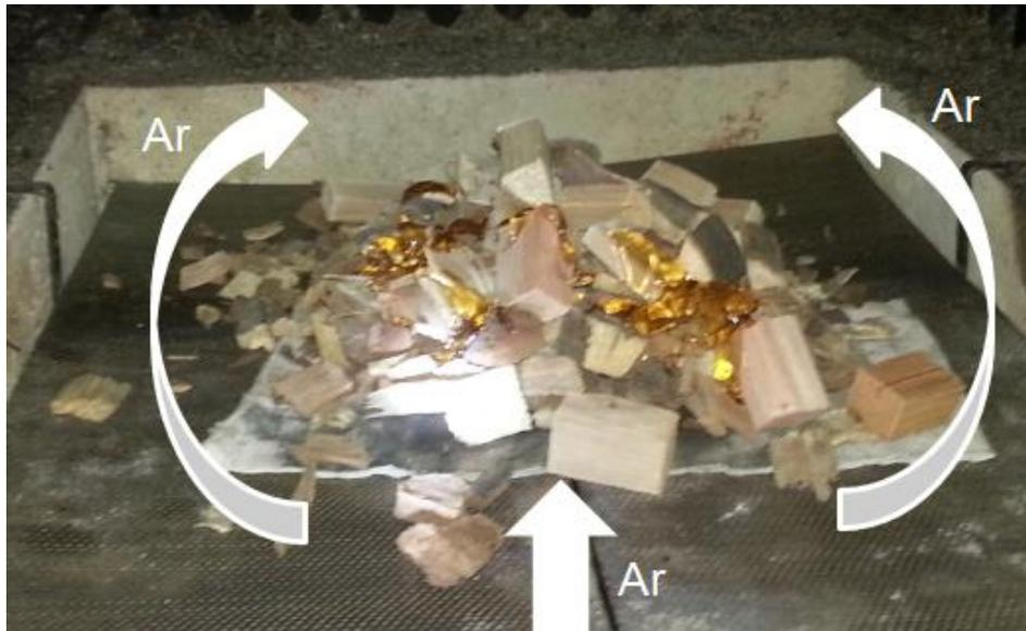
Figura 21: Esquema da passagem do ar primário pela grelha e pela biomassa.
