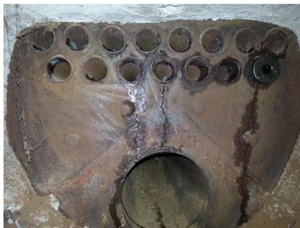
Figura 4: Vazamento nos tubos após a pressão ser elevada a 9 kgf/cm<sup>2</sup>.
