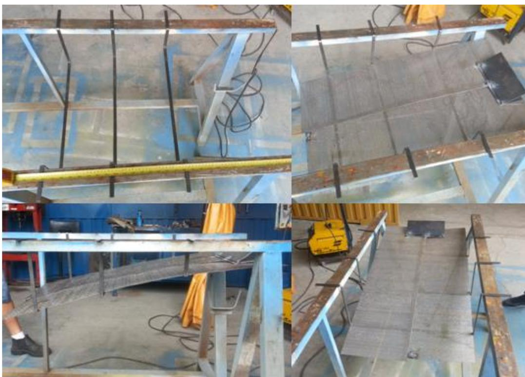
Figura 147: Processo de fabricação da grelha inclinada na GNS Usinagem.
