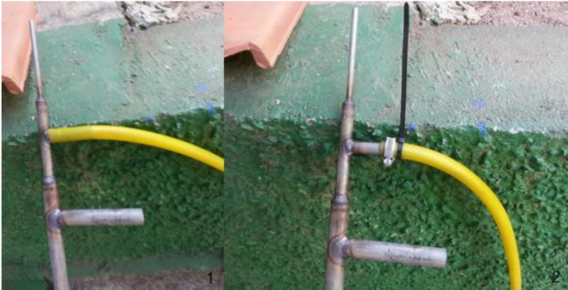
Figura 100: Sonda sendo preparada para o teste de estanqueidade na GNS Usinagem.
