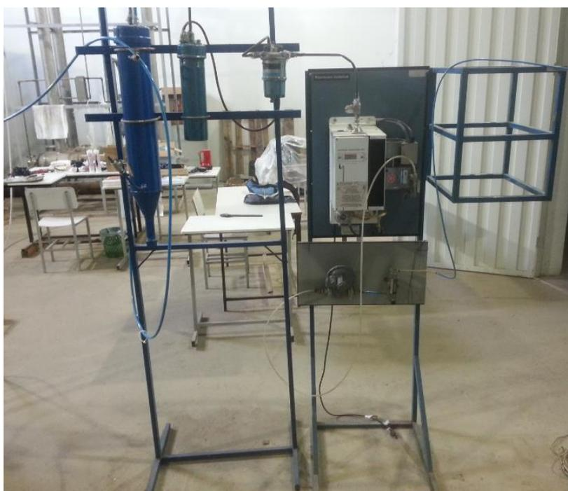
Figura 108: Sistema de amostragem dos gases de combustão do leito para a análise.
