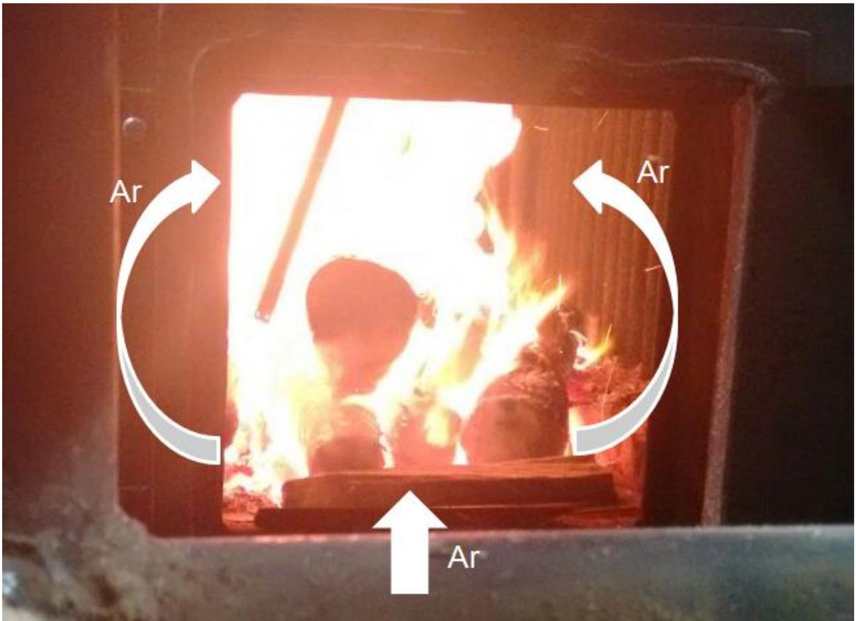
Figura 23: Chamas formadas pela reação do ar com os voláteis da biomassa em regime permanente de combustão.
