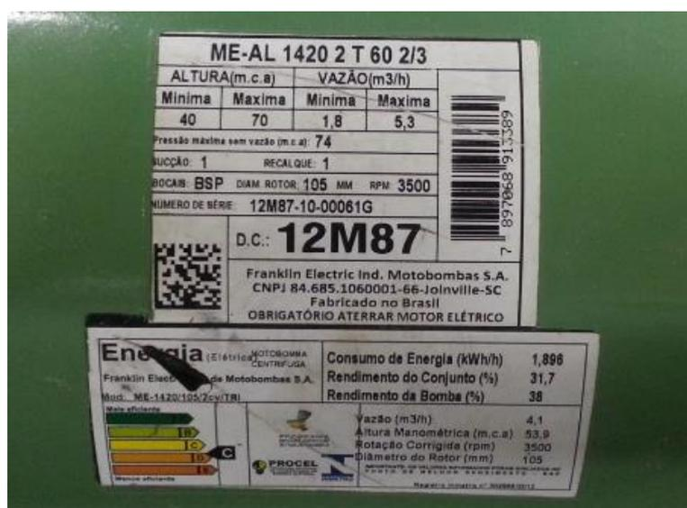
Figura 104: Dados da bomba usada no circuito de água da sonda.
