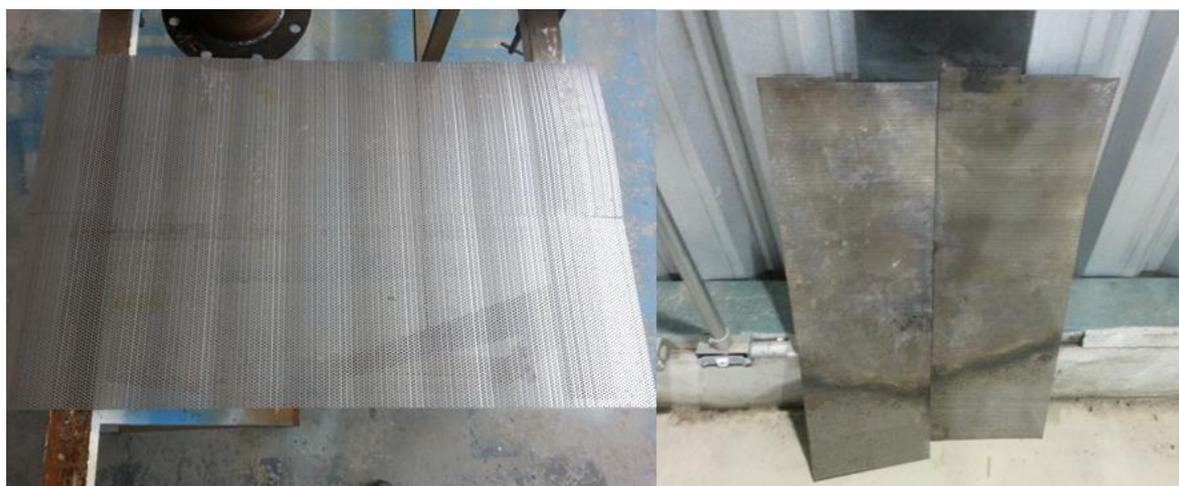
Figura 94: Chapa da grelha cortada e soldada pronta para ser usada.
