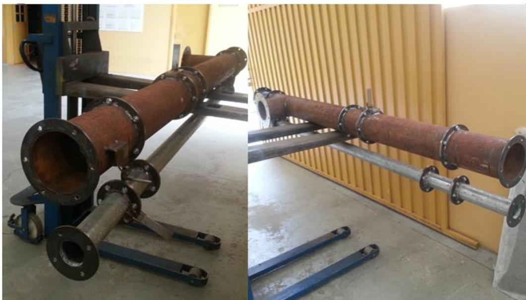
Figura 133: Teste de montagem da tubulação completa na GNS Usinagem.
