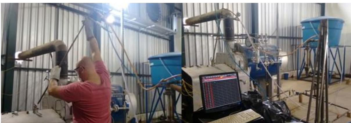
Figura 152: Primeira inserção da sonda na câmara de combustão.
