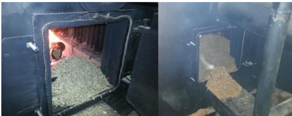
Figura 149: Serragem acumulada na entrada da câmara de combustão.
