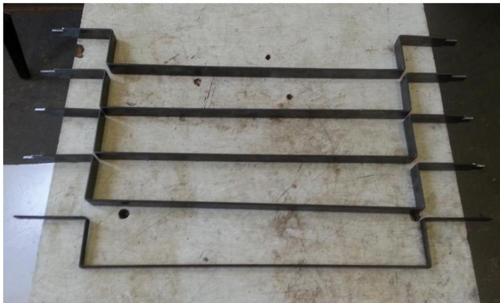
Figura 95: Suportes da grelha, um de 10 [mm] e quatro de 20 [mm].
