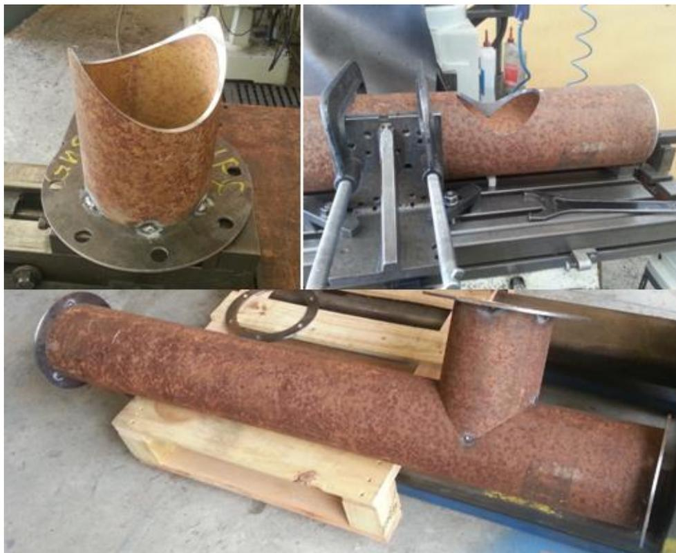
Figura 122: Tubo Usinado em T durante usinagem na GNS Usinagem.
