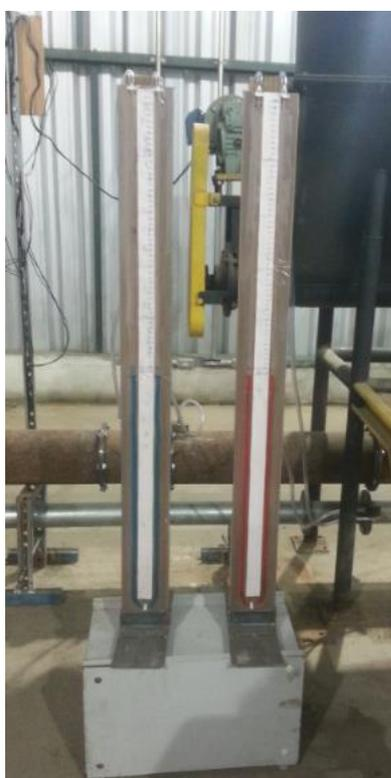
Figura 130: Manômetros em U nas tomadas de pressão das placas de orifício.
