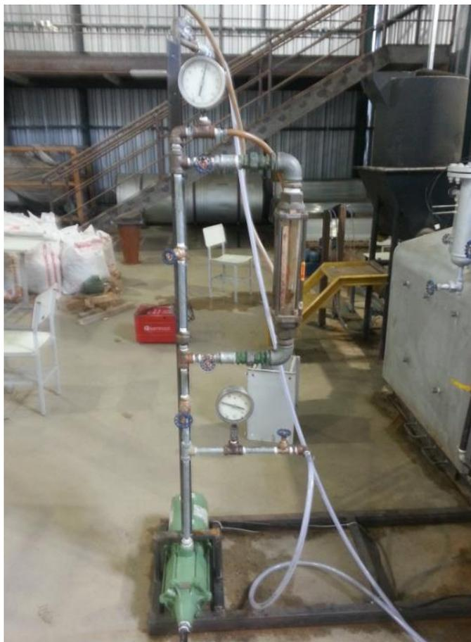
Figura 151: Teste de vazão na sonda.
