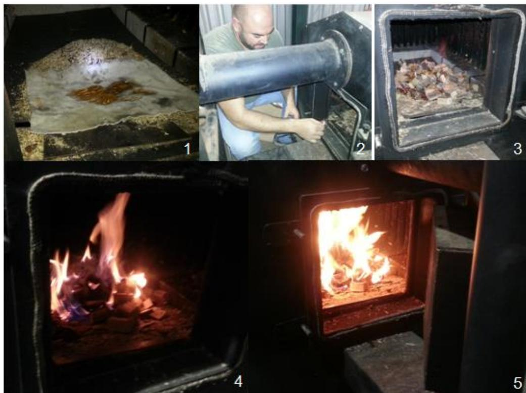
Figura 143: Sequência de ignição na câmara de combustão.
