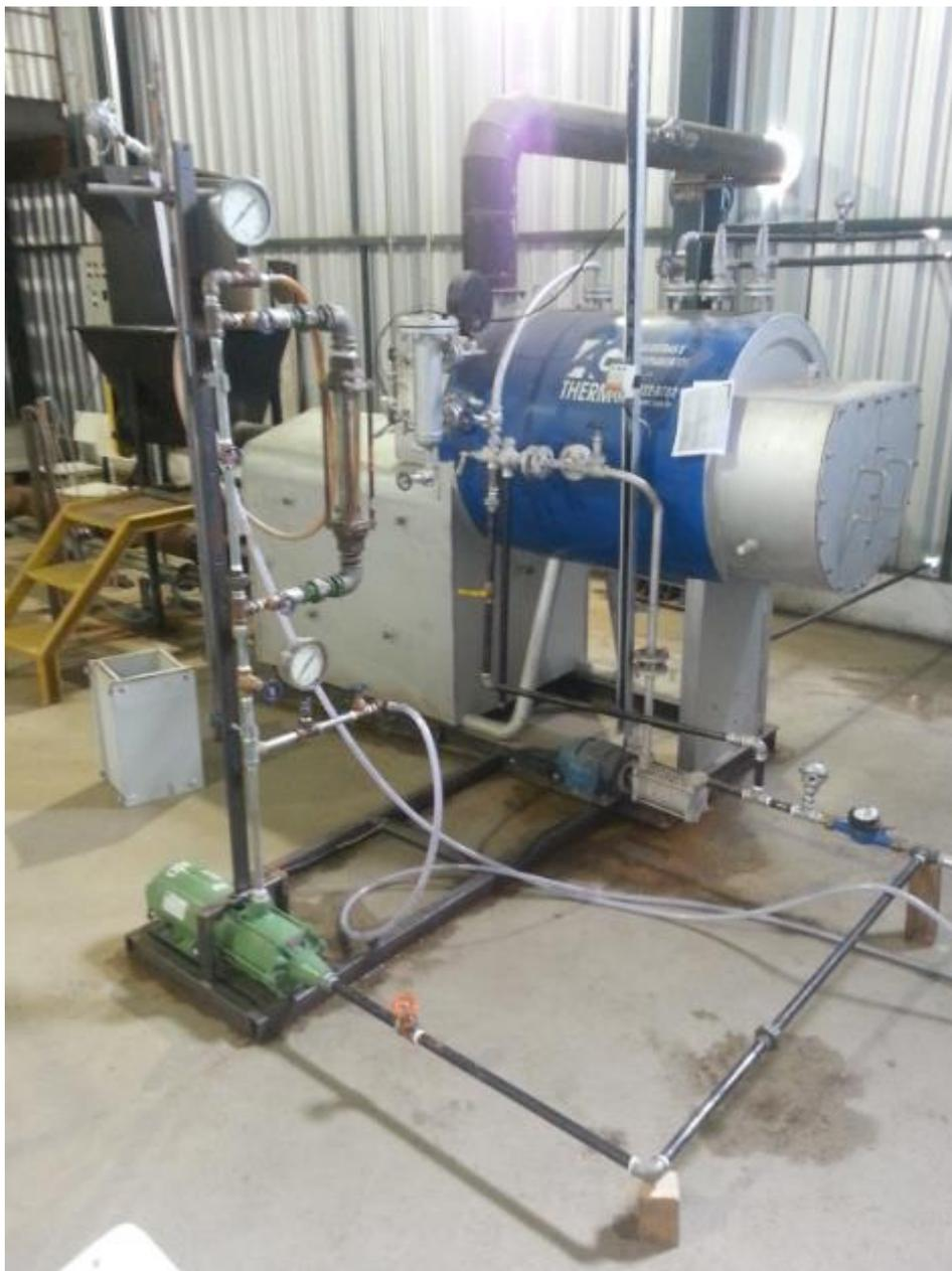
Figura 106: Circuito de água da sonda.
