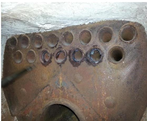
Figura 3: Vazamento nos tubos após a pressão ser elevada a 6 kgf/cm<sup>2</sup>.
