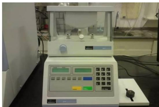
Figura 52: Balança conectada ao Analisador CHNSO da Perkin Elmer series II 2400. (Oliveira, 2014).
