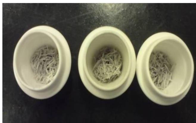
Figura 54: Amostras depois de realizada à análise termogravimétrica.
