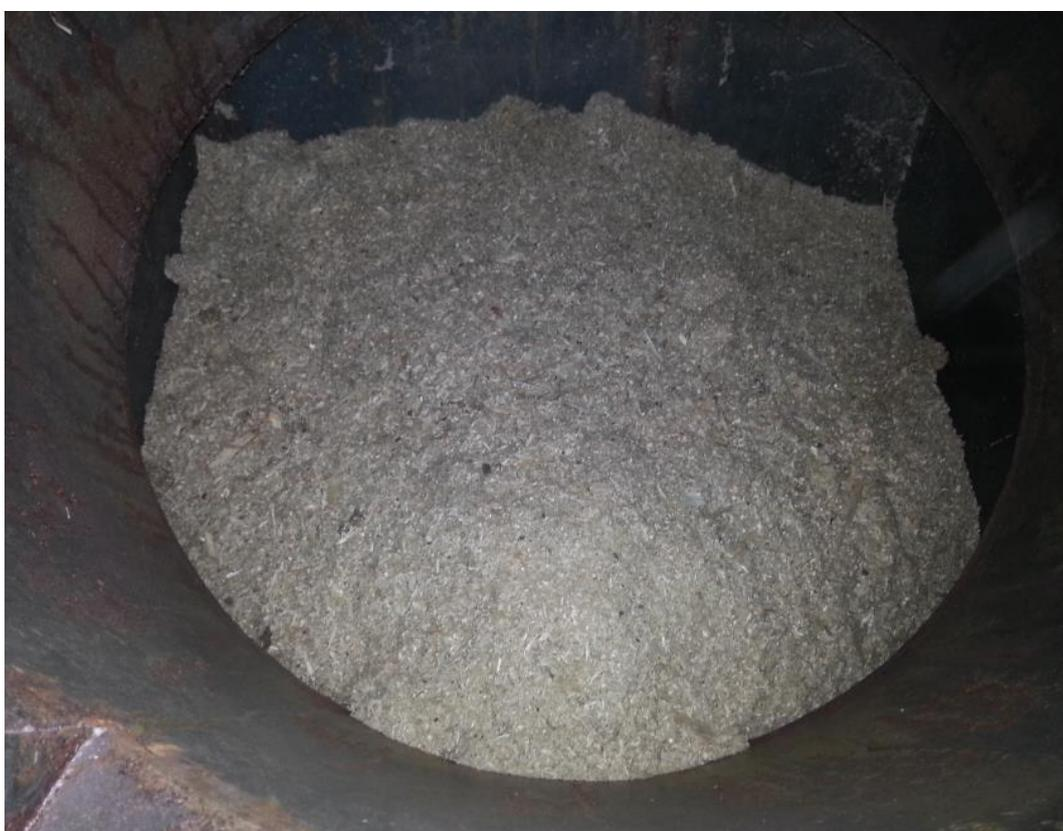
Figura 142: Serragem de eucalipto no silo do alimentador.
