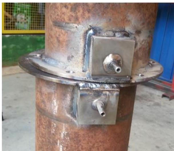
Figura 127: Tomadas de pressão da placa de orifício para a tubulação de ar primário.
