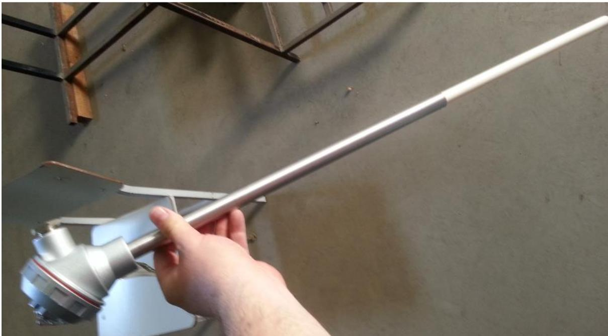
Figura 135: Termopar tipo B montado pela Alutal Controles Industriais LTDA para o NEST/IEM/UNIFEI.
