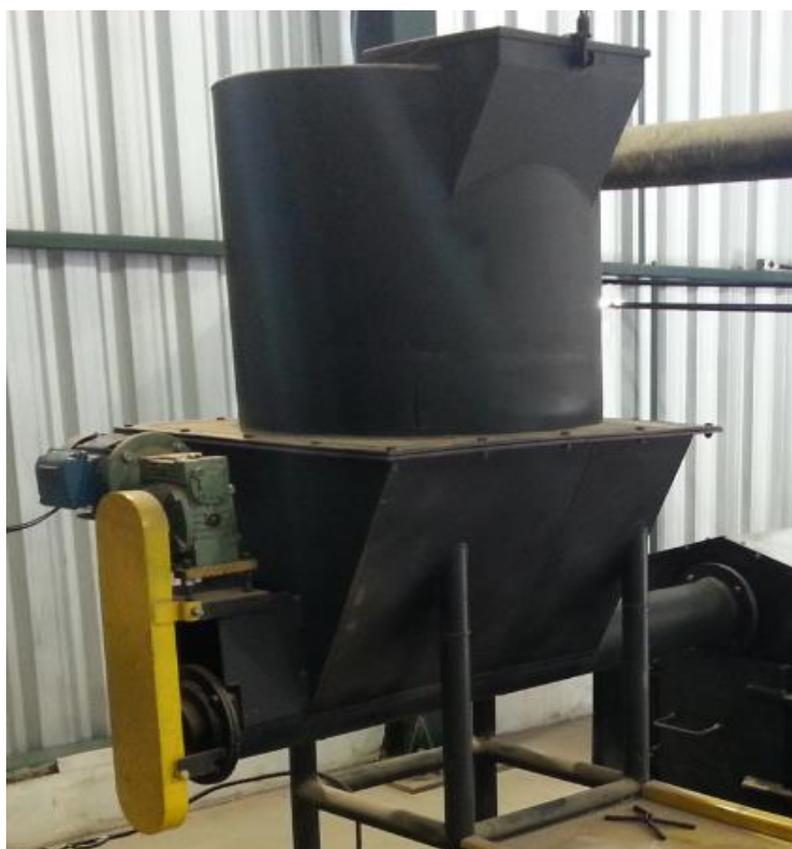
Figura 63: Alimentador em destaque no esquema da caldeira.
