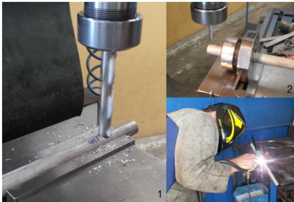
Figura 98: Usinagem e soldagem dos tubos da sonda.
