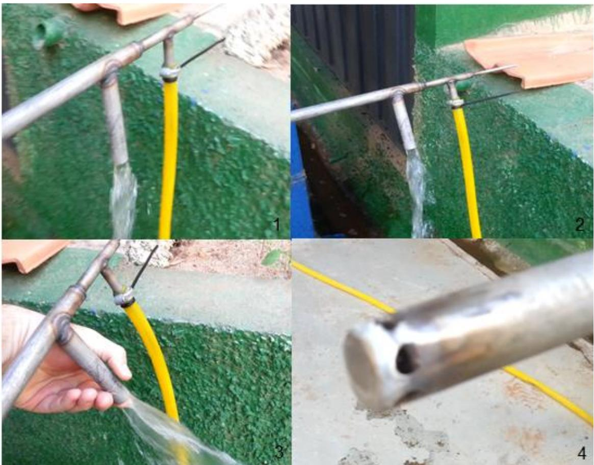
Figura 101: Teste de estanqueidade da sonda realizado na GNS Usinagem.
