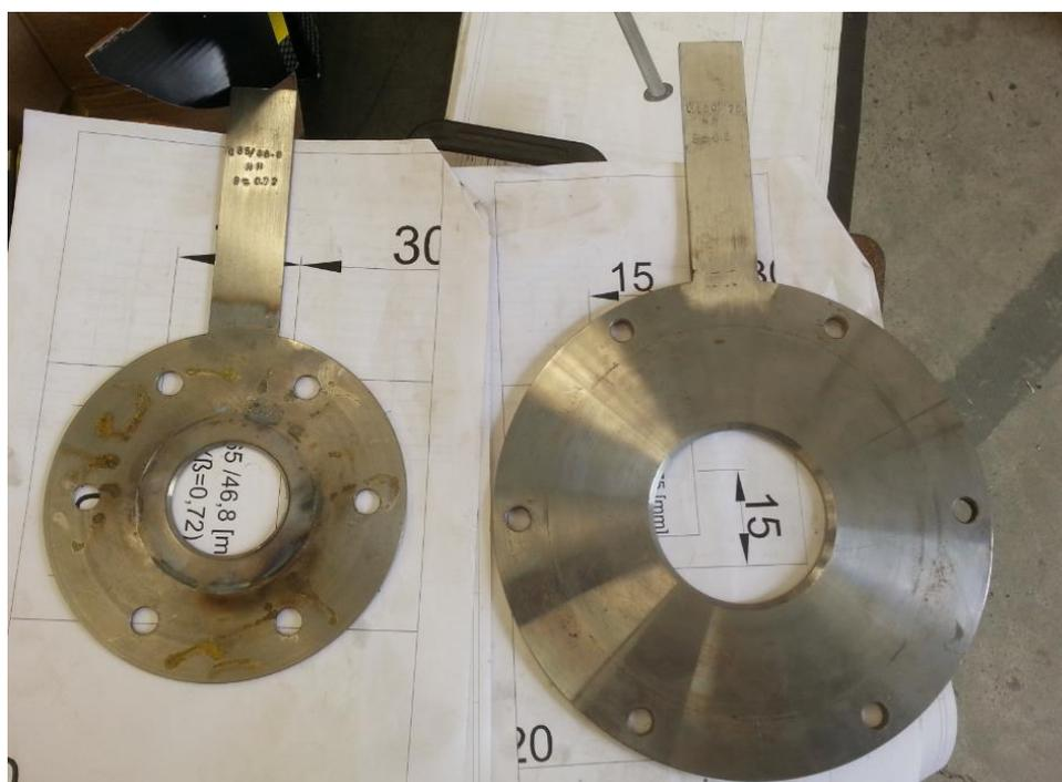
Figura 126: Placas de orifício para as tubulações de ar secundário e primário respectivamente.
