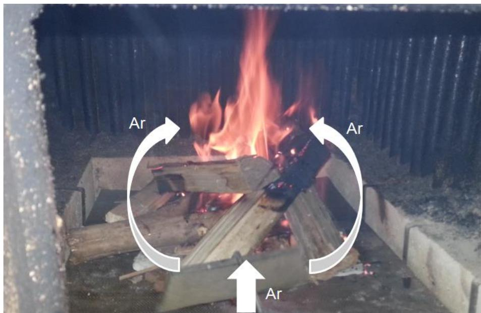
Figura 22: Mistura do ar com os voláteis da biomassa em início de processo de combustão.
