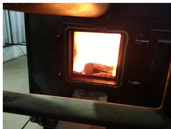
Figura 7: Caldeira em operação, fornalha queimando lenha de eucalipto.
