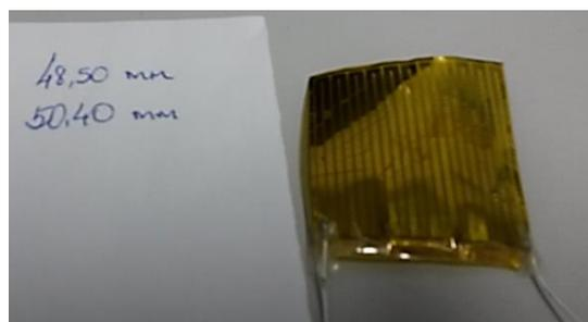
Figura 4.2 – Aquecedor Resistivo com medidas.
