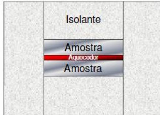
Figura 4.8 – Esquema da montagem (corte vista superior).
