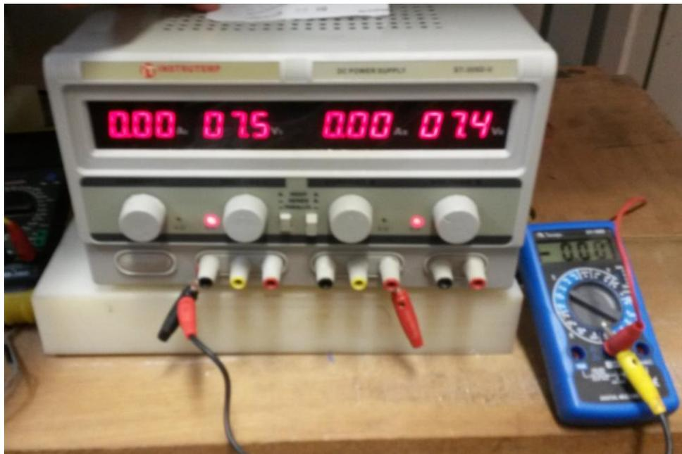
Figura 4.3 – Fonte de alimentação digital Instrutemp ST 305D-II.
