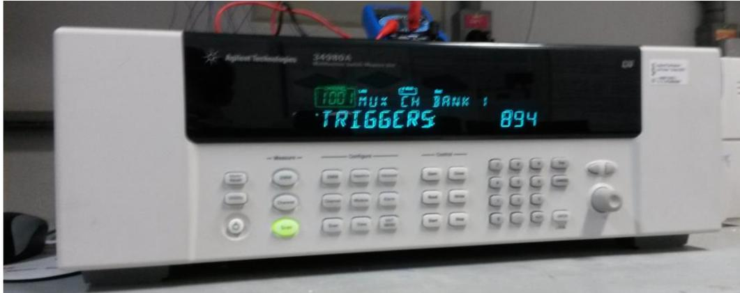
Figura 4.6 – Equipamento de aquisição de dados Agilent 34980A.
