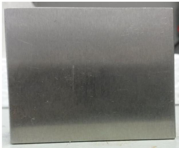
Figura 4.13 – Detalhe de acabamento das amostras de aço Inox AISI 304.
