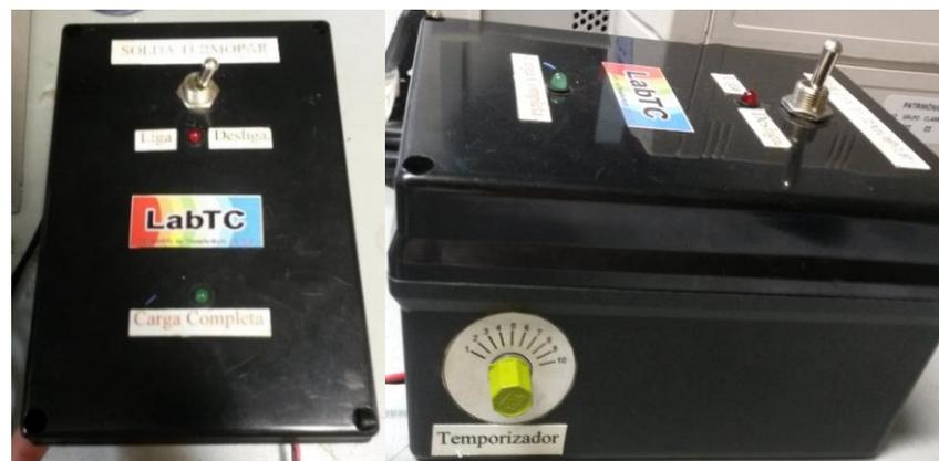
Figura 4.5 – Equipamento de descarga capacitiva desenvolvido no LabTC.
