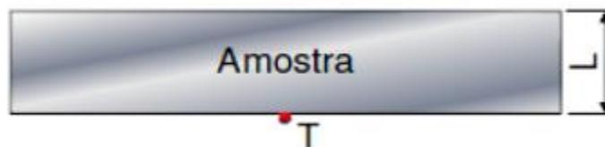
Figura 4.11 – Posição do termopar na amostra.
