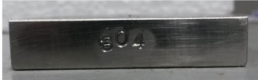
Figura 4.12 – Detalhe de acabamento das amostras de aço Inox AISI 304.
