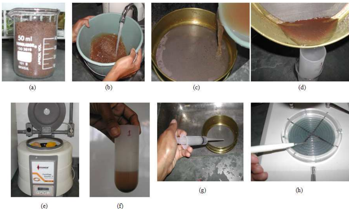
FIGURA 8 - (a) Amostra de solo (50 mL), (b) Lavagem da amostra de solo, (c) Passagem da suspensão pelas peneiras, (d) Material retido na peneira de 0,053 mm, (e) Centrifugação, (f) Tubo de centrifuga com suspensão de solo sobrenadante e solução de sacarose, (g) placa concêntrica para contagem dos esporos em lupa
