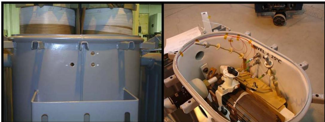
Figura 3.30 – Posicionamento dos penetradores no tanque.
