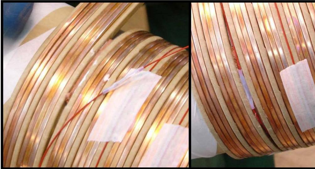
Figura 3.22 – Instalação dos sensores no enrolamento de BT.
