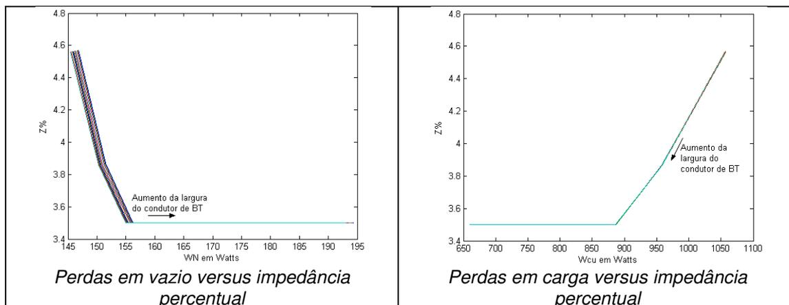
Figura A1.14 – Perdas em vazio e em carga em relação à impedância percentual considerando a variação da largura do condutor de BT e com variação do diâmetro do condutor de AT.
