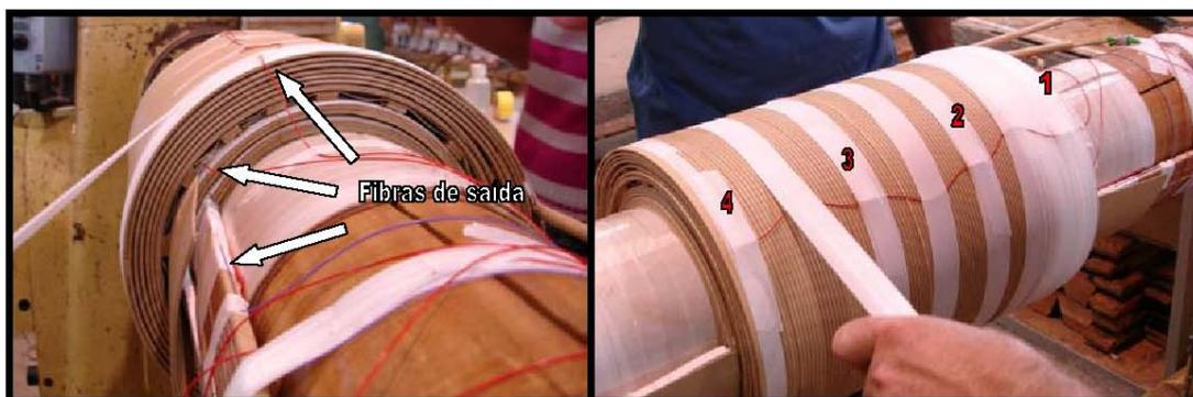
Figura 3.28 – Posicionamento dos sensores no enrolamento de AT.
