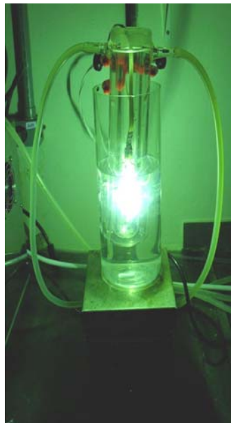
Figura 6 – Foto reator com a lâmpada ( \lambda_{\text{máx}} = 365 \text{ nm} ) no interior da jaqueta durante o processo foto-Fenton
