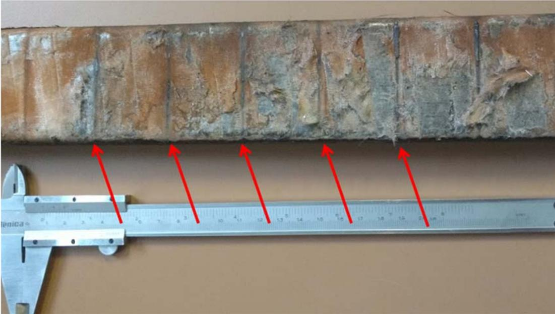
**Figura 43 - Desgastes na barra estatórica.**
