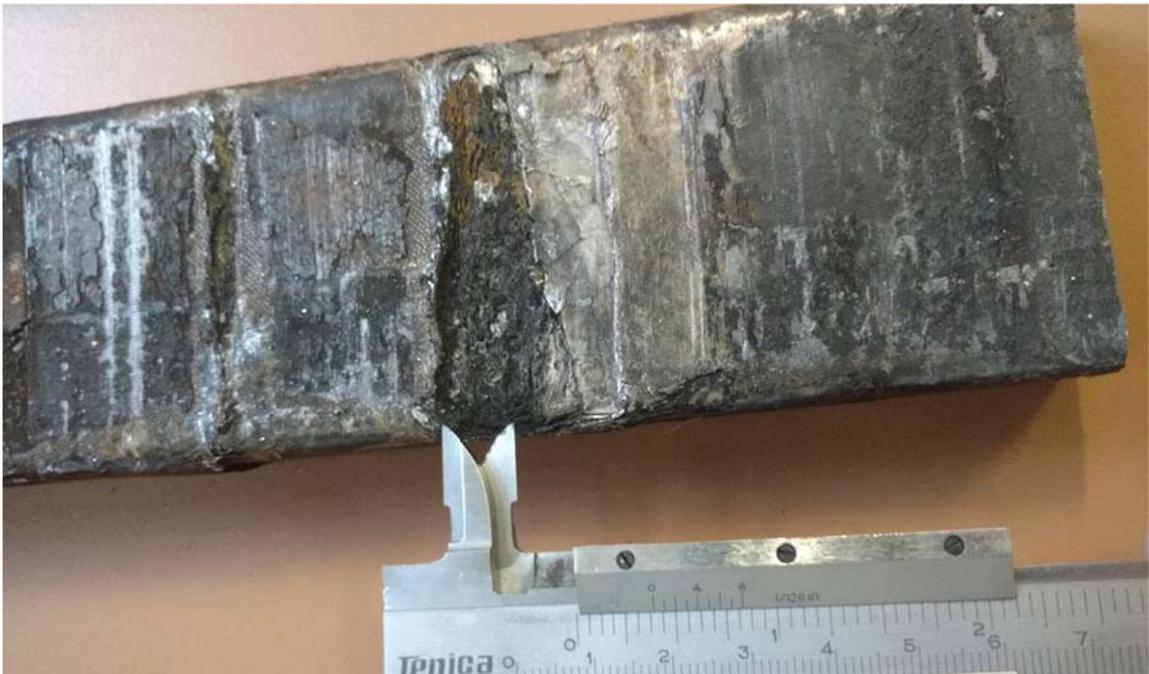
**Figura 44 - Ponto de Falha do Isolante.**
