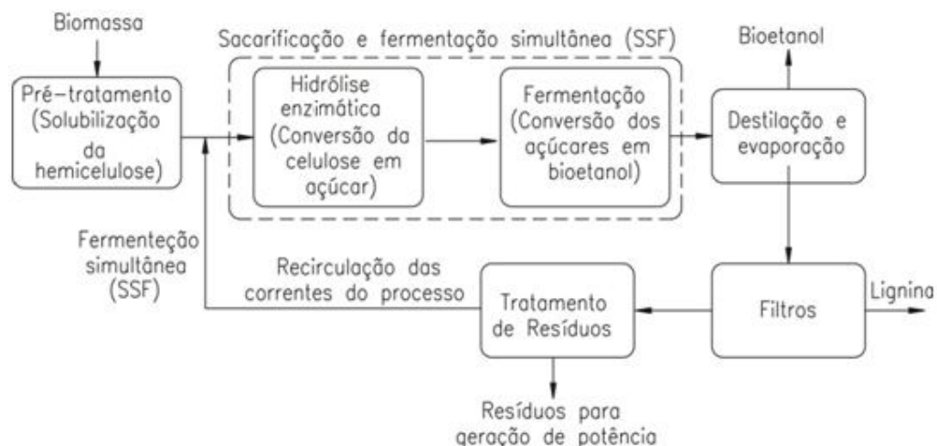
Figura 15. Diagrama de fluxo para o processo de bioconversão da biomassa utilizando o processo de hidrólise enzimática (Hahn-Hägerdal et al. , 2006).
