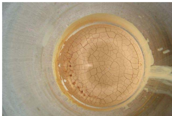
Figura 16: Pó precursor de PZT após moagem em moinho de bolas.
