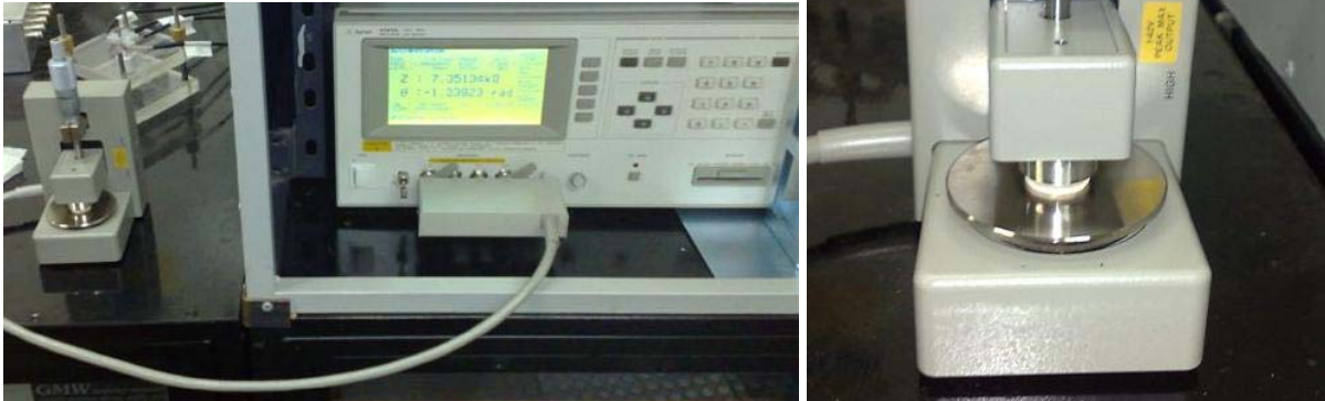
Figura 34: Foto do equipamento utilizado para realizar a espectroscopia de impedância. Porta amostra com parafuso micrométrico.
