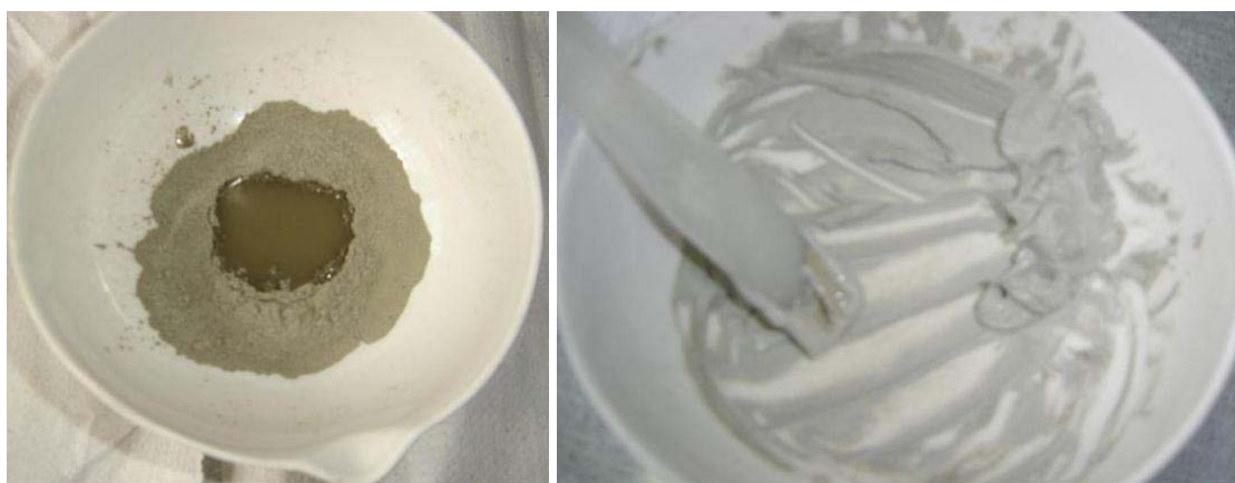
Figura 18: (a): Água destilada adicionada à mistura de cimento e PZT; (b): pasta formada.
