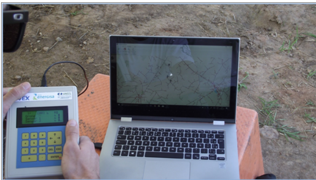
Figura 60 – Teste de comunicação - Central de operação e software georreferenciado.
