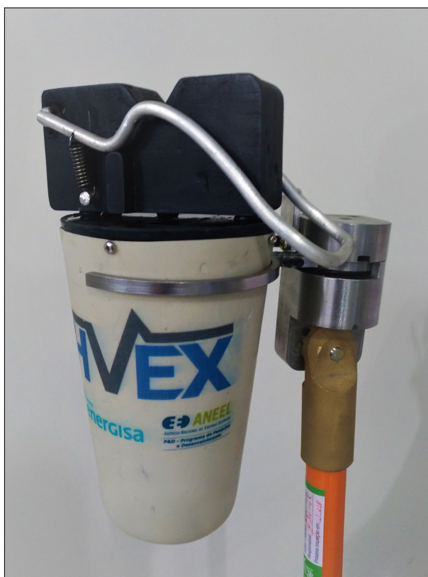
Figura 33 – Sinalizador desenvolvido pra instalação temporária.
