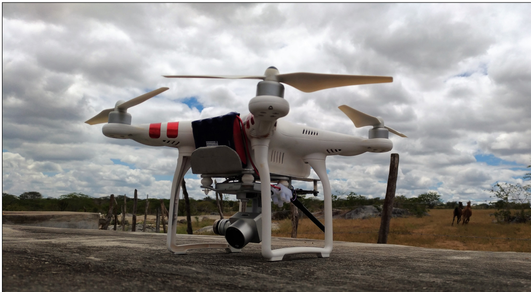
Figura 56 – Drone com o circuito eletrônico repetidor.
