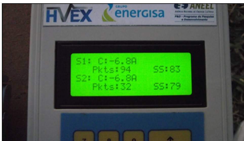
Figura 40 – Resultado da comunicação entre os sinalizadores 1 e 2 com a central.
