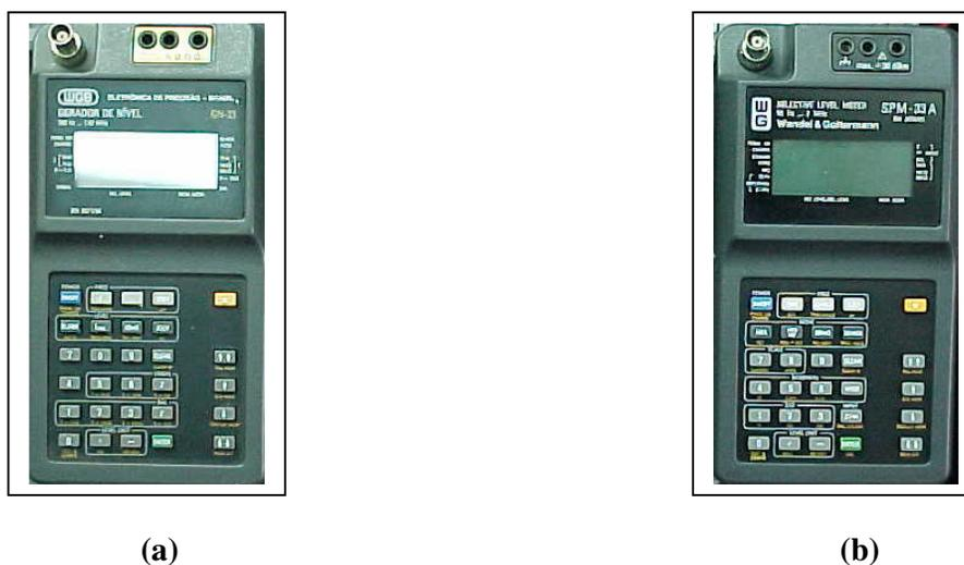
**Figura 113 - Gerador (a) e Medidor de Nível (b)**
