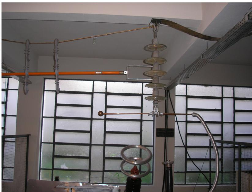
**Figura 66 - Ensaio do garfo na cadeia de isoladores de vidro.**
