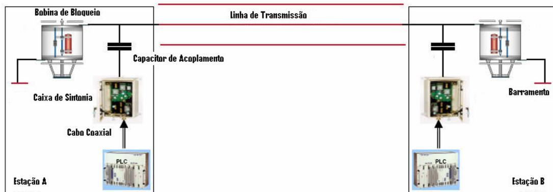
Figura 3- Terminal de Onda Portadora em Linha de Transmissão Básica. [Areva]
