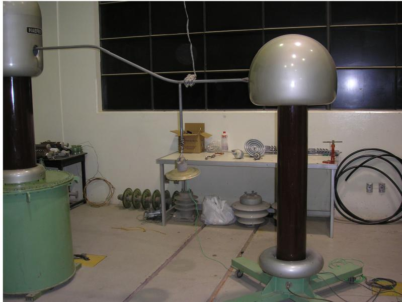
**Figura 40 - Ensaio tensão de ruptura dos isoladores – LAT.**
