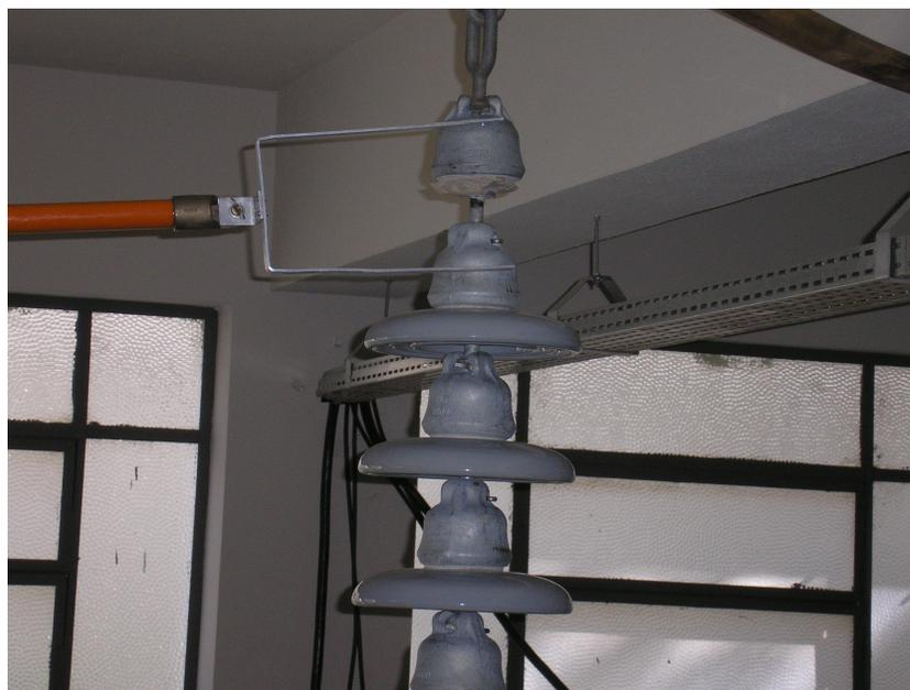
**Figura 74 - Ensaio do garfo em um isolador de porcelana quebrado.**
