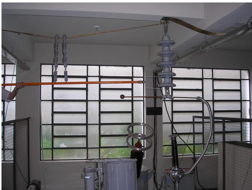
**Figura 73 - Ensaio do garfo com isoladores de porcelana.**
