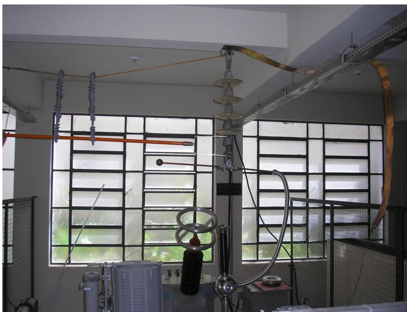
**Figura 67 - Ensaio do garfo com um dos isoladores de vidro quebrado.**
