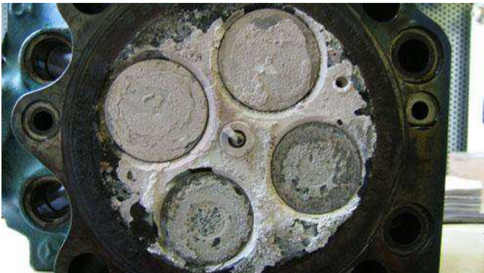
Figura 32: Deposição de sílica nos equipamentos de conversão energética. Fonte: DESOTEC (2015).
