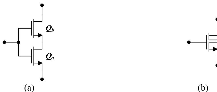
Figura 3.1 – Transistor composto: (a) esquemático e (b) símbolo.
