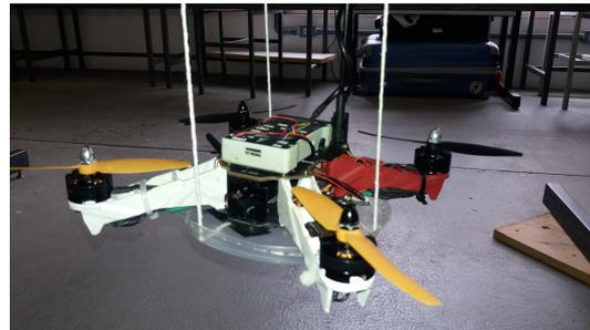
(d) Ensaio trifilar  $I_{zz}$ .**Figura 6.3:** Configuração dos ensaios para cálculo de momentos de inércia.
