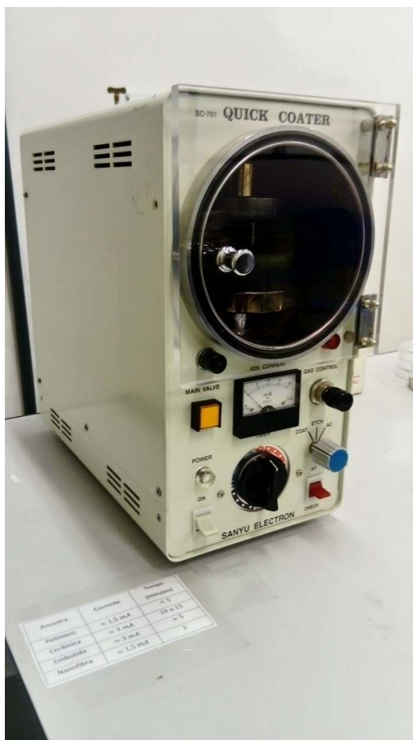
Figura 36 - Equipamento para metalização de amostras para preparação de ensaio no MEV.
