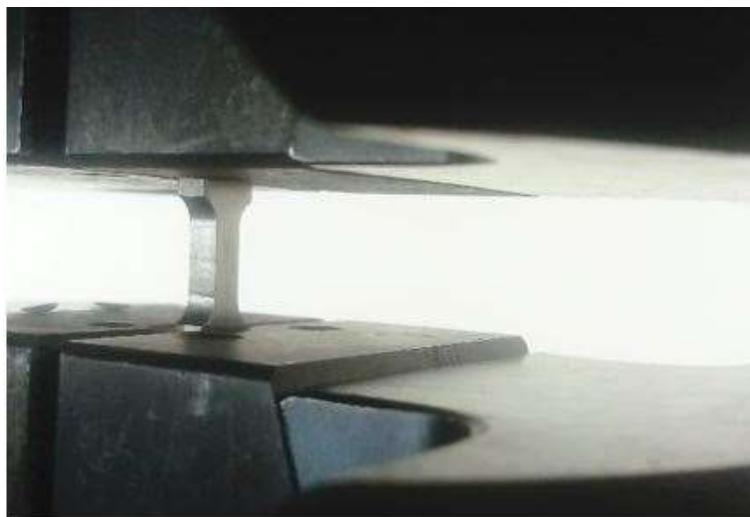
Figura 26 - Corpo de prova de ensaio de tração preso às garras no momento do ensaio.
