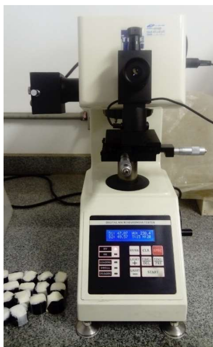
Figura 33 - Microdurômetro Time, mod.: TH712 utilizado para aquisição das durezas nas regiões soldadas.
