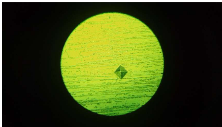
Figura 34 - CP identado visto pela lente de um microscópio ótico.
