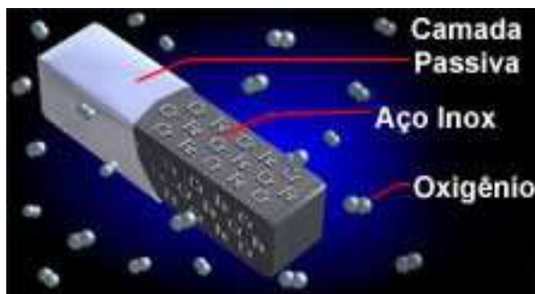
Figura 1 - Figura esquemática da formação da camada passiva nos AIs.
