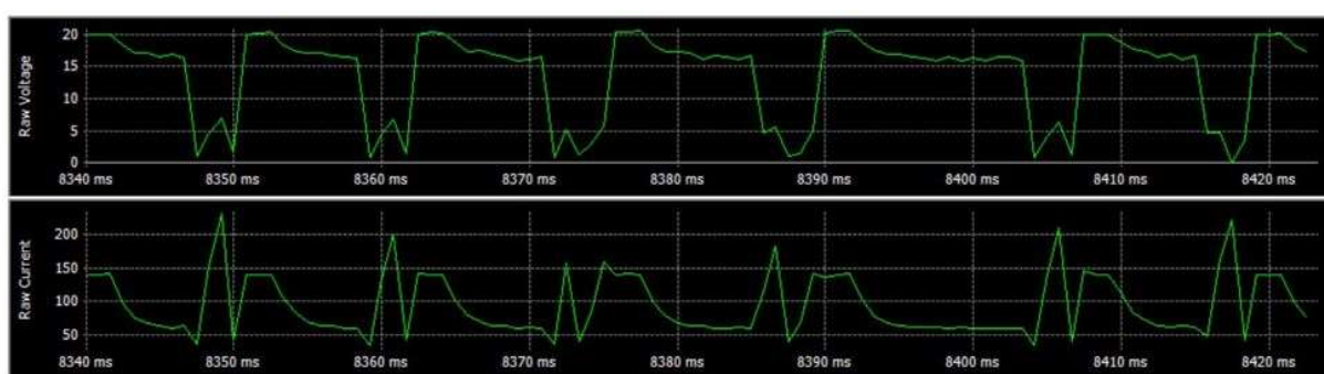
Figura 20 - Espectro da corrente e tensão elétrica aquisitado durante a soldagem.
