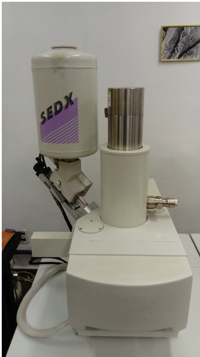
Figura 37 - Microscópio Eletrônico de Varredura - MEV utilizado para caracterização das amostras.
