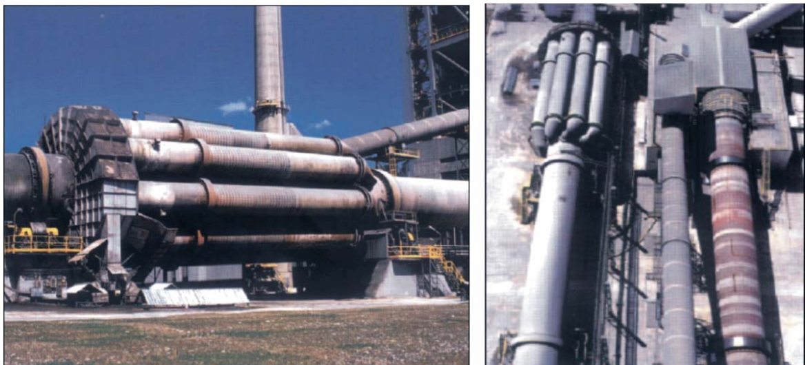
Figura 36 - Resfriador satélite ou planetário, vista lateral e superior. (Fonte: Rees e Christensen, 2000).
