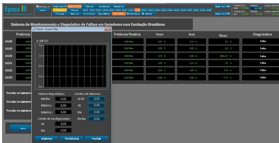
Figura 52 – Tela de acompanhamento de tendências e limite de alarmes
