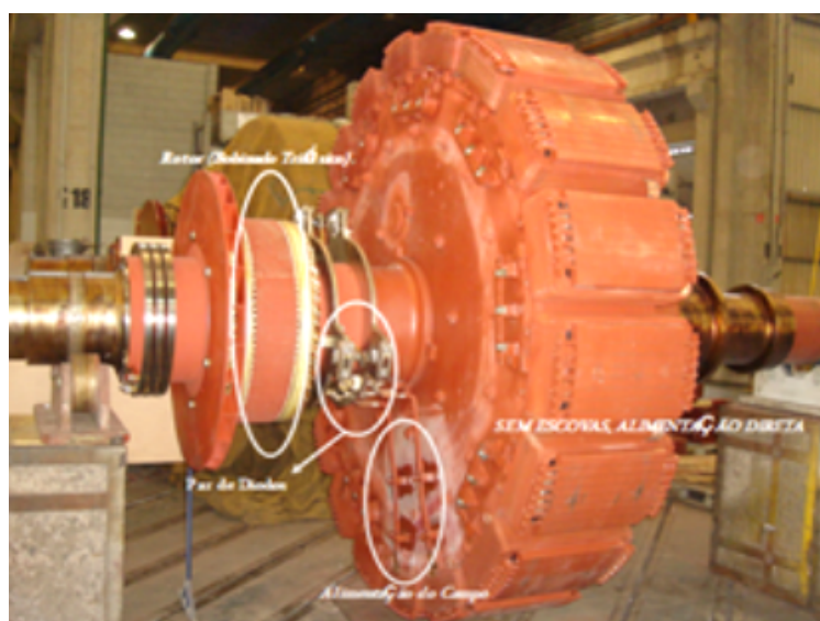
Figura 8 – Rotor de polos salientes de um gerador trifásico.
