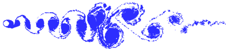
(a) Ponto A: posição dos vórtices na esteira.
