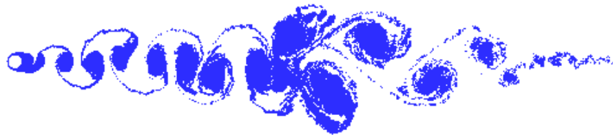
(a) Ponto E: Posição dos vórtices na esteira.
