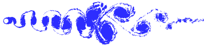
(a) Ponto C: Posição dos vórtices na esteira.
