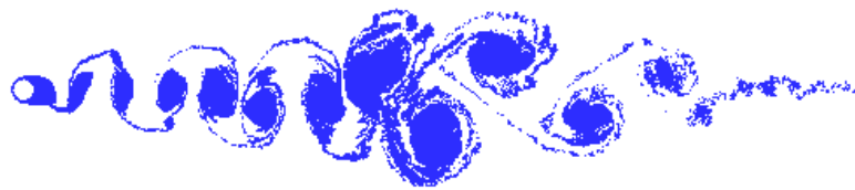
(a) Ponto B: Posição dos vórtices na esteira.
