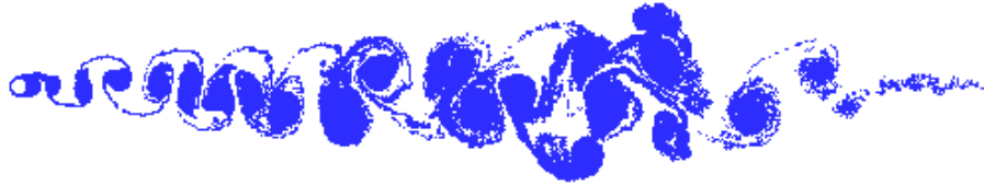
Figura 6.10 – Posição dos vórtices na esteira ao final da simulação numérica do cilindro circular isolado (Euler, mb = 300 , \Delta t = 0,05 , \sigma_0 = \text{eps} = 0,001 , Re = 10^5 ).
