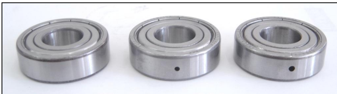
Figura 6.1: Rolamentos modelo 6203-ZZ, utilizados no experimento: (da esquerda para a direita) normal, furo de \phi 2,3 mm e \phi 2,8 mm.
