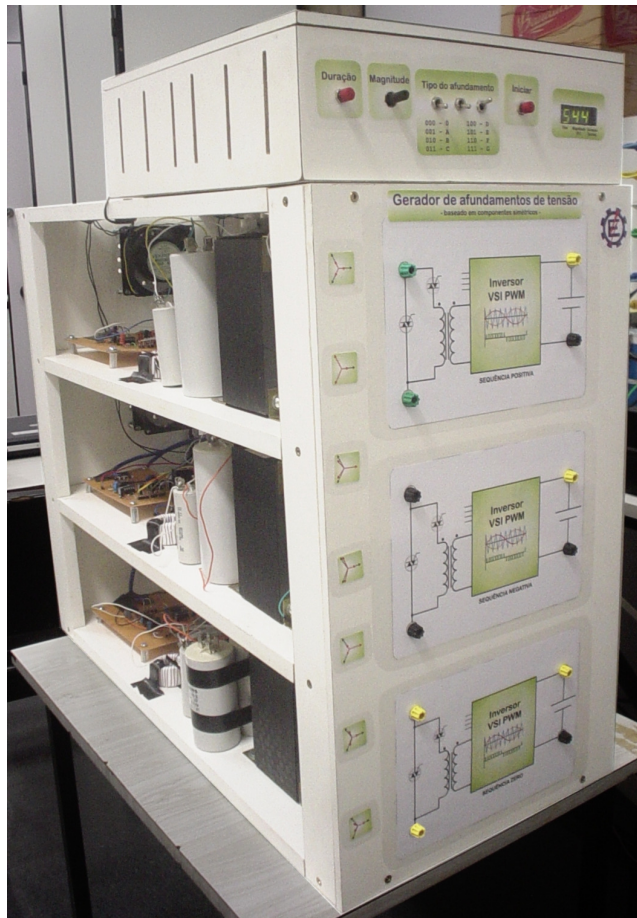
Figura 5.15 – Foto da estrutura do gerador
