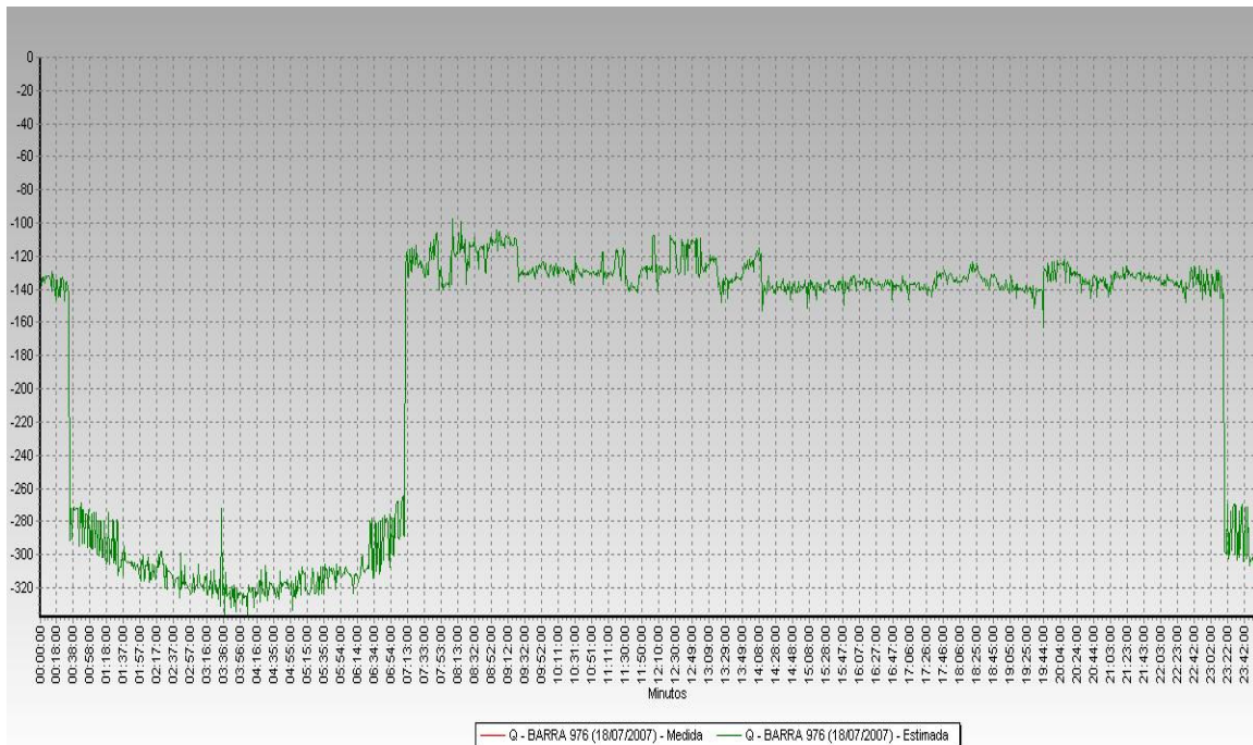
Figura 13 –SE Gravataí – 525 kV (Barra # 976): Injeção de Potência Reativa – Medidos (Vermelho) x Estimados (Verde)
