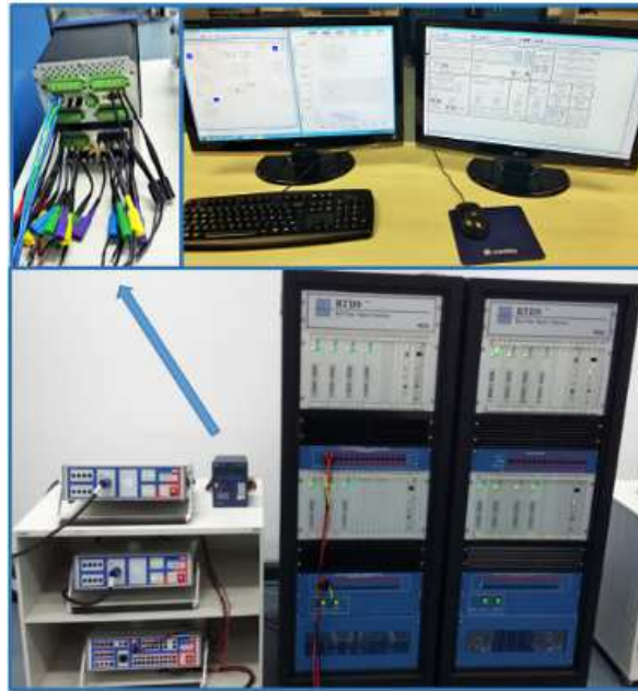
Figura 3.37 - Fotos dos equipamentos utilizados na simulação. No sentido horário i) Rack do RTDS; ii) Relé de Proteção SEL-710; iii) Amplificadores CMS 156; iv) Mala de testes CMS 256.
