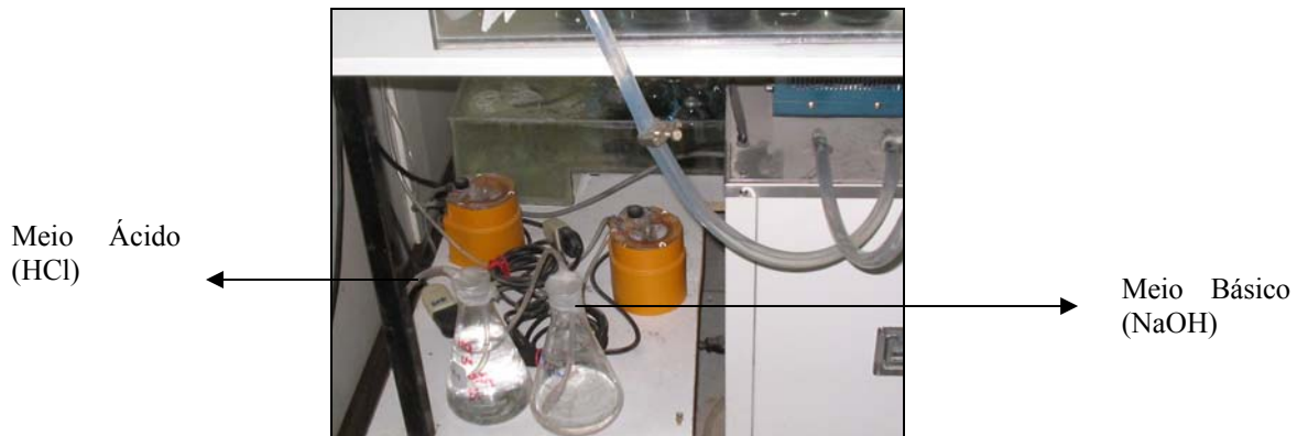
Figura 4. 17: Meio ácido e básico para controle de pH.
