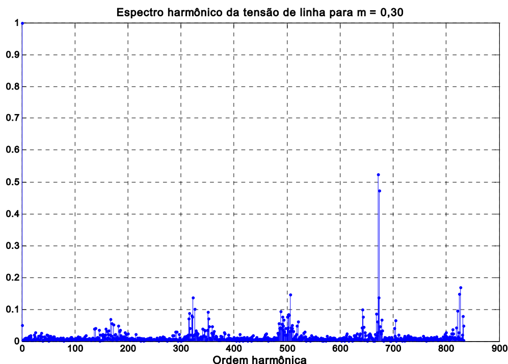
Figura 7.16 – Espectro harmônico da tensão fase-fase para m = 0,30
