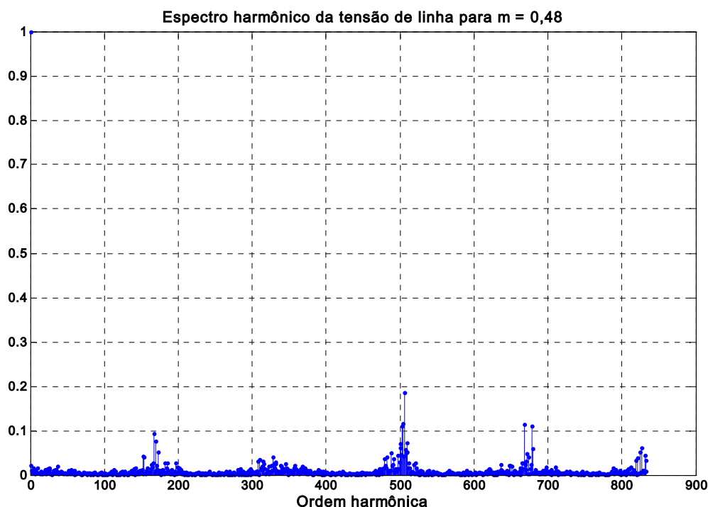
Figura 7.18 – Espectro harmônico da tensão fase-fase para m = 0,48
