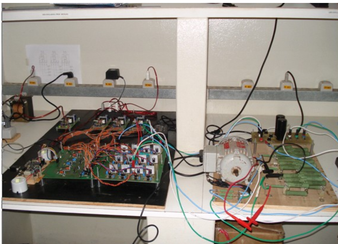
Figura 6.22 – Visão geral do protótipo do inversor 3 níveis
