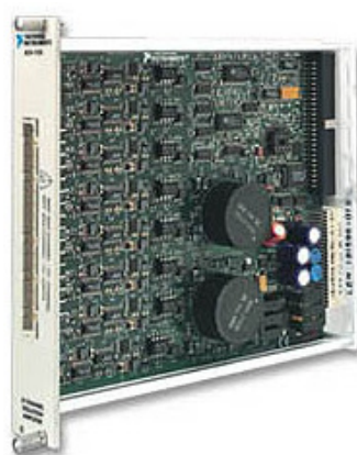
FIGURA 63 - Módulo SCXI-1125, National Instruments (fonte: SCXI-1125, 2007)
