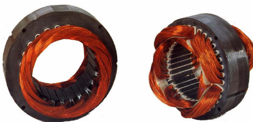
FIGURA 23 - Enrolamentos imbricado e ondulado (fonte: BORTONI e SANTOS, ca. 2000)
