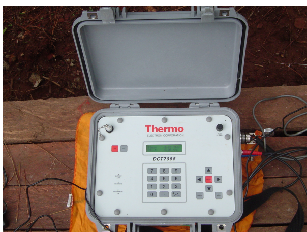
FIGURA 70 - Medidor ultra-sônico de vazão, entrada da turbina Michell-Banki
