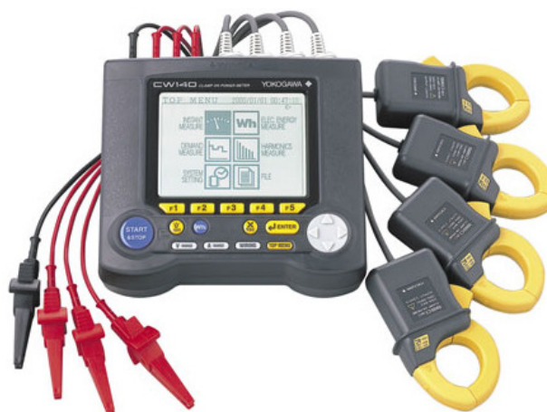
FIGURA 61 - Medidor de grandezas elétricas Yokogawa CW140 (fonte: CLAMP-ON, 2007)
