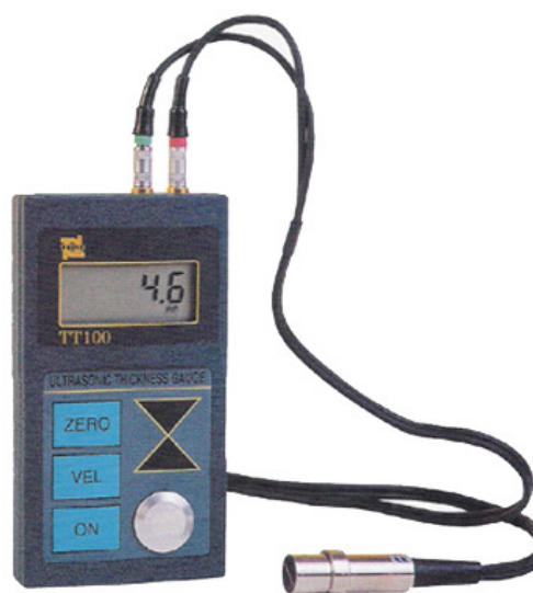
FIGURA 58 - Medidor de espessura de conduto forçado Homis TT100 (fonte: HOMIS, 2007)
