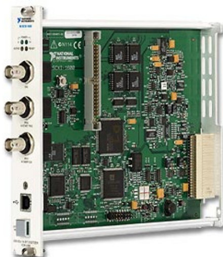
FIGURA 66 - Módulo SCXI-1600, National Instruments (fonte: USB, 2007)
