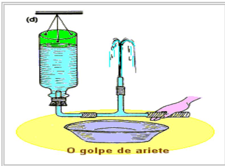
4- Adapte o conjunto (c) na boca da garrafa e, apertando com os dedos o tubinho de látex livre, encha a garrafa com água. Quando cheia, solte o tubinho de látex permitindo o escoamento de água.
