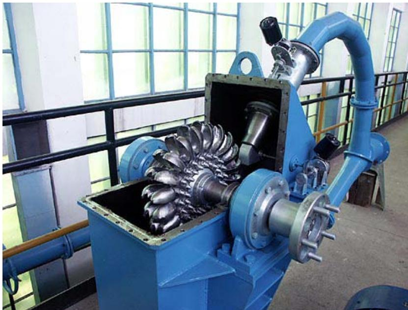
Figura 23 – Foto de uma turbina Pelton - Fonte Autogreen (2009)
