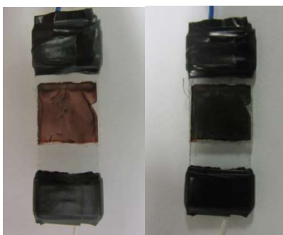
Figura 5.14: Janela inteligente obtida com filme electrocrômico de P3HT-co-EDOT 2:1 em diferentes estados de oxidação: esquerda = estado reduzido a -0,5 V; direita = estado oxidado a 2,0 V.
