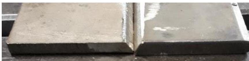
Figura 4.2 - Junta chanfrada em “V” 60^\circ com nariz de 1 mm.
