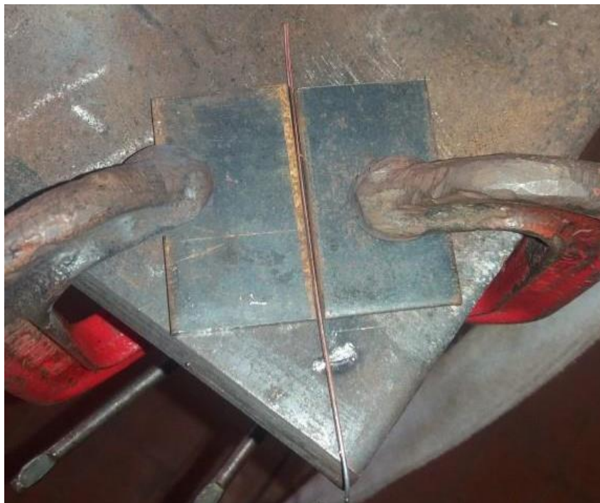
Figura 4.11 - Corpo de prova fixado com gabarito para afastamento de 1 mm.
