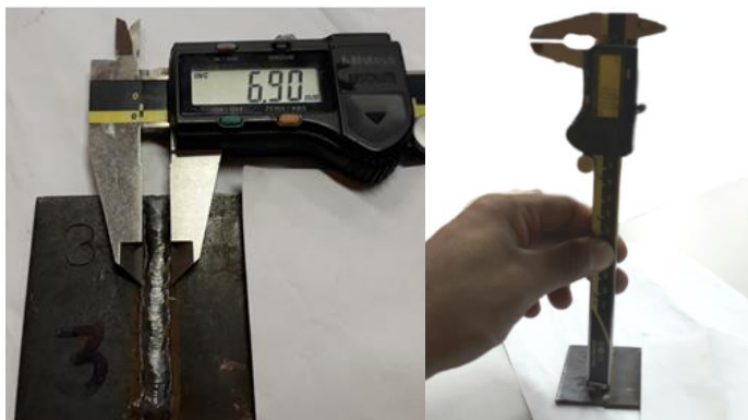
Figura 4.12 - Medição da peça 3 de aço SAE 1020 espessura 1/8" sem chanfro e afastamento 1mm.
