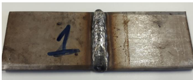
Figura 4.13 - Peça 1 de aço inoxidável ASTM 240-13c. Largura do cordão 10,40 mm e Altura 2,70 mm.
