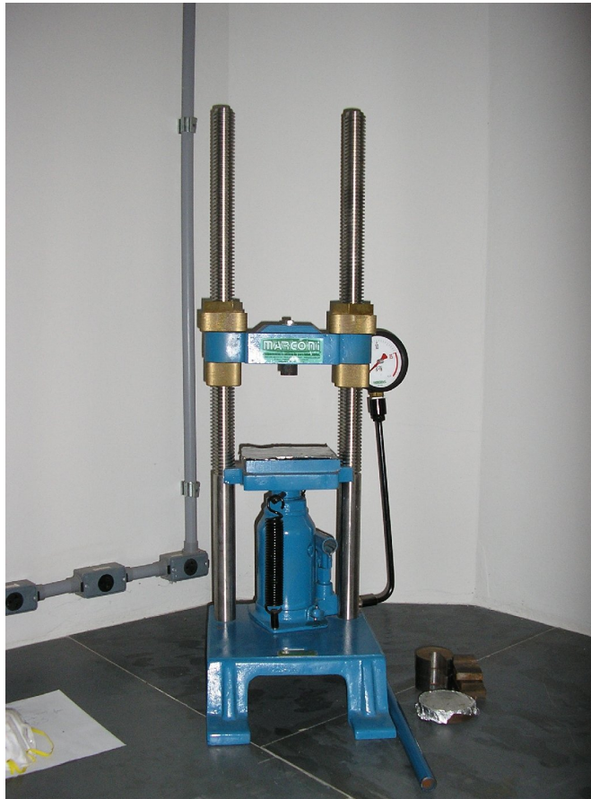
Figura 3.5 - Prensa uniaxial manual Marconi MA 098/A Fonte: Laboratório de materiais cerâmicos do ICE/UNIFEI
