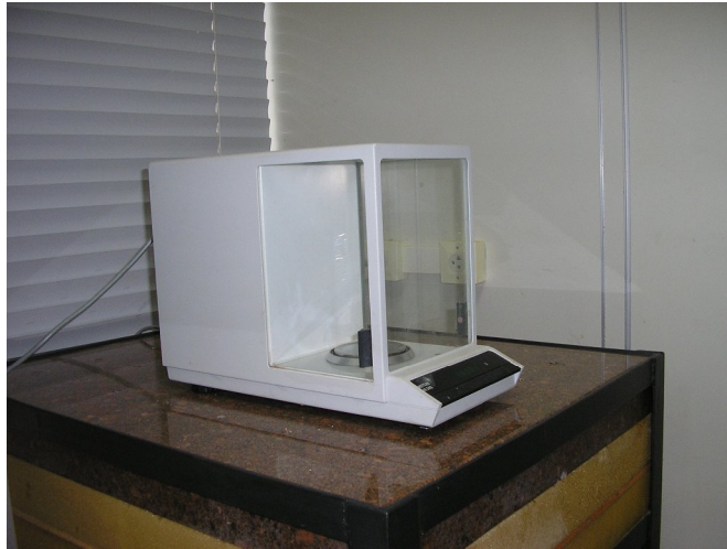
Figura 3.2 - Balança analítica METTLER AE 240 Fonte: Laboratório de materiais cerâmicos do ICE/UNIFEI
