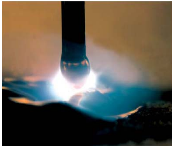
Figura 2.5-Modo de transferência por curto-circuito (Bracarense et al, 2004).
