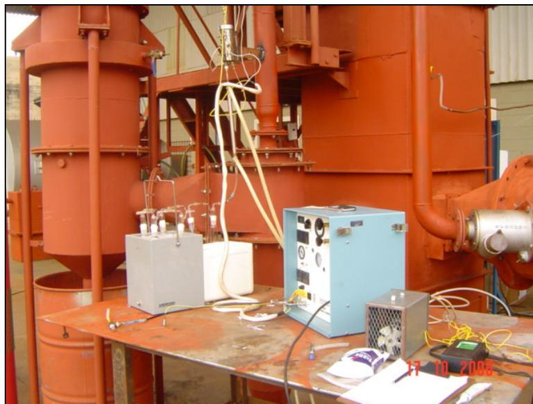
Figura 21. Testes de análise de alcatrão no gás produzido no gaseificador de Duplo estágio da Termoquip
