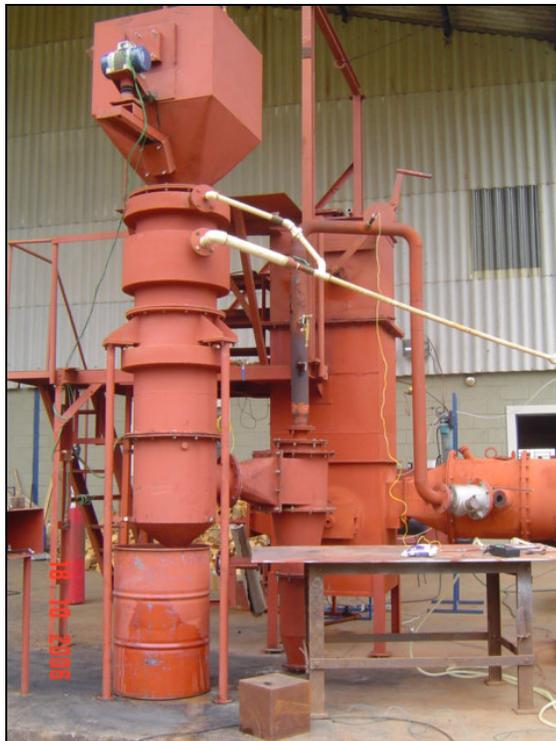
Figura 20. Gaseificador de Duplo estágio da Termoquip
