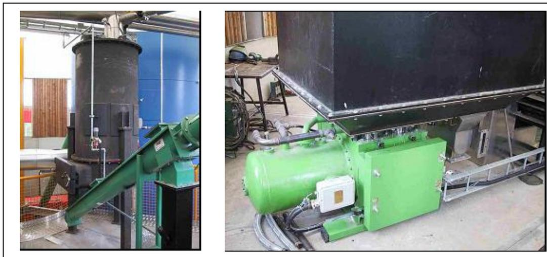
Figura 33. Sistema de geração gaseificador / motor Stirling
