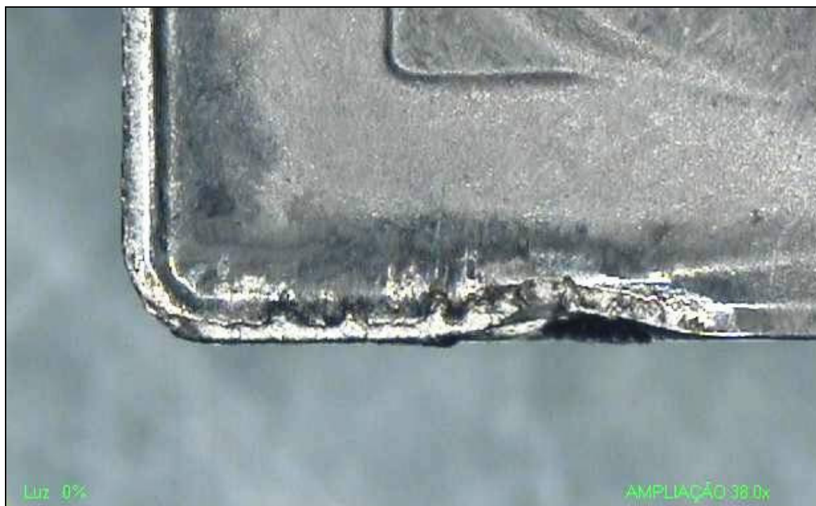
Figura 5.7 – Superfície de saída - Inserto de metal duro IC428 (ISO K05). Usinagem com refrigeração (41X).
