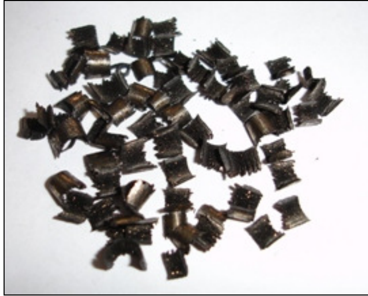
Figura 5.19 – Cavaco obtido com inserto IC4028. V_c=150 m/min, f=0,4 mm/volta, a_p=4 mm.
