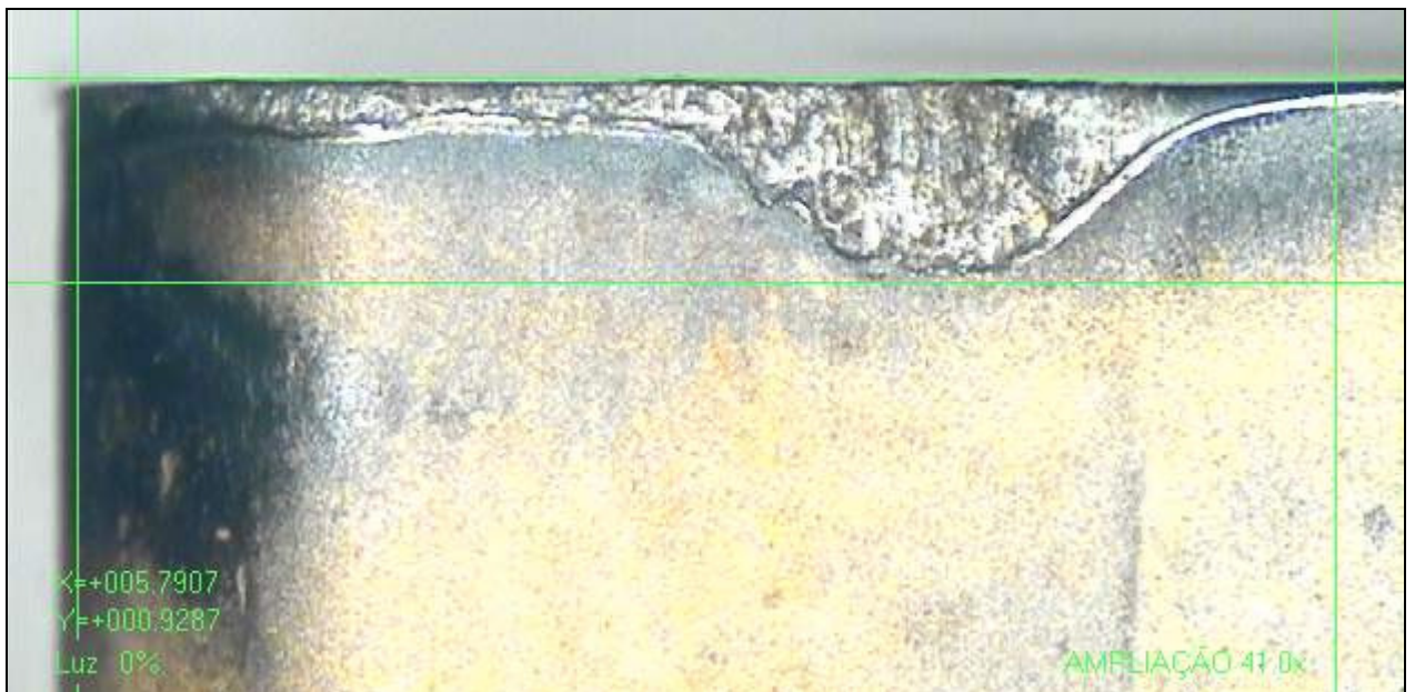
Figura 5.16 – Superfície de folga - Inseto de metal duro IC4028 (ISO K10). Usinagem sem refrigeração (41X).
