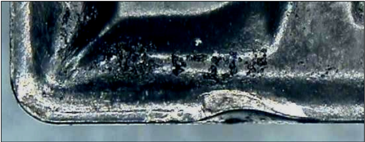
Figura 5.4 – Superfície de saída - Inserto de metal duro IC8048 (ISO K10).
