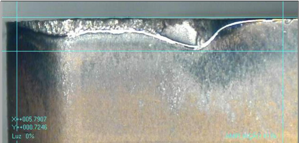
Figura 5.10 – Superfície de folga - Inseto de metal duro IC4028 (ISO K10). Usinagem com refrigeração (41X).
