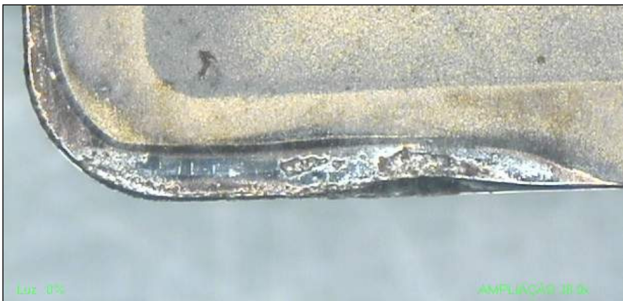
Figura 5.9 – Superfície de saída - Inseto de metal duro IC4028 (ISO K10).
