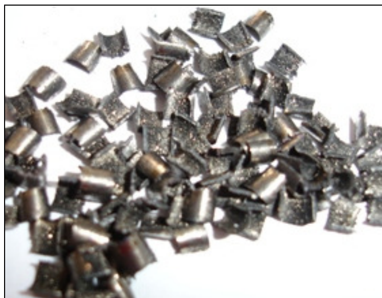
Figura 5.17 – Cavaco obtido com inserto IC8048. V_c=100 m/min, f=0,4 mm/volta, a_p= 4 mm.
