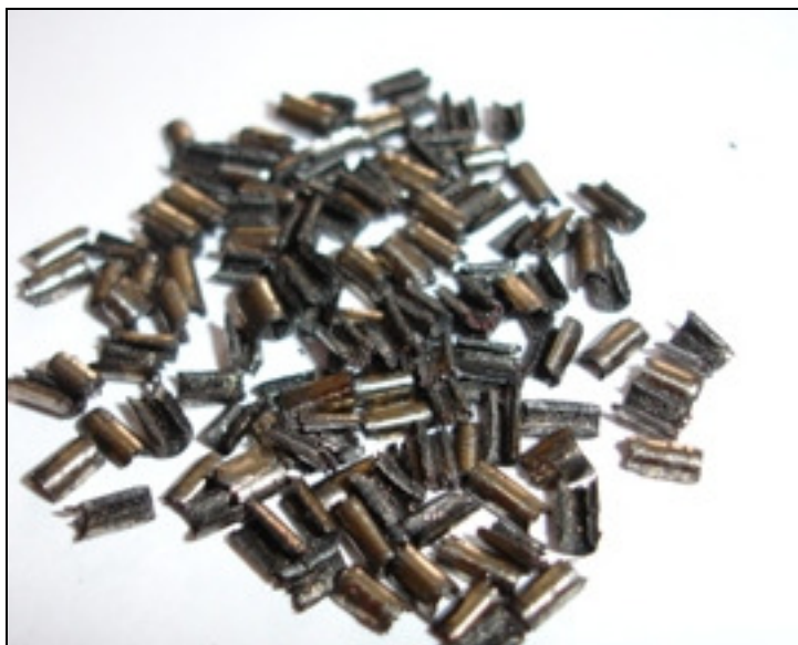
Figura 5.18 – Cavaco obtido com inserto IC428. V_c=150 m/min, f=0,4 mm/volta, a_p=4 mm.
