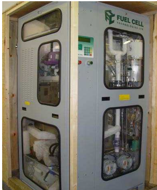
Figura 18 – SOFC de 5 kW fornecida pela FC Technologies.
