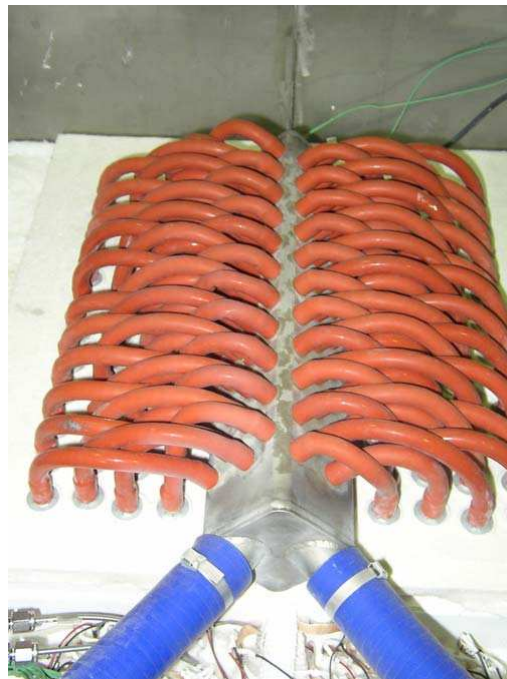
Figura 24 – Sistema de distribuição do ar.
