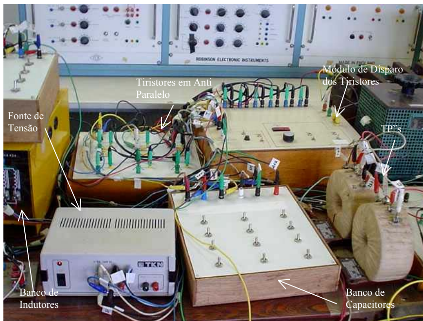
Figura A.13 – Circuito de Controle de Tensão da Carga do Gerador de Indução
