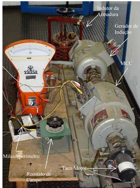
Figura A.8 – MCC, Taco Motor, Gerador, Reostato e Amperímetro
