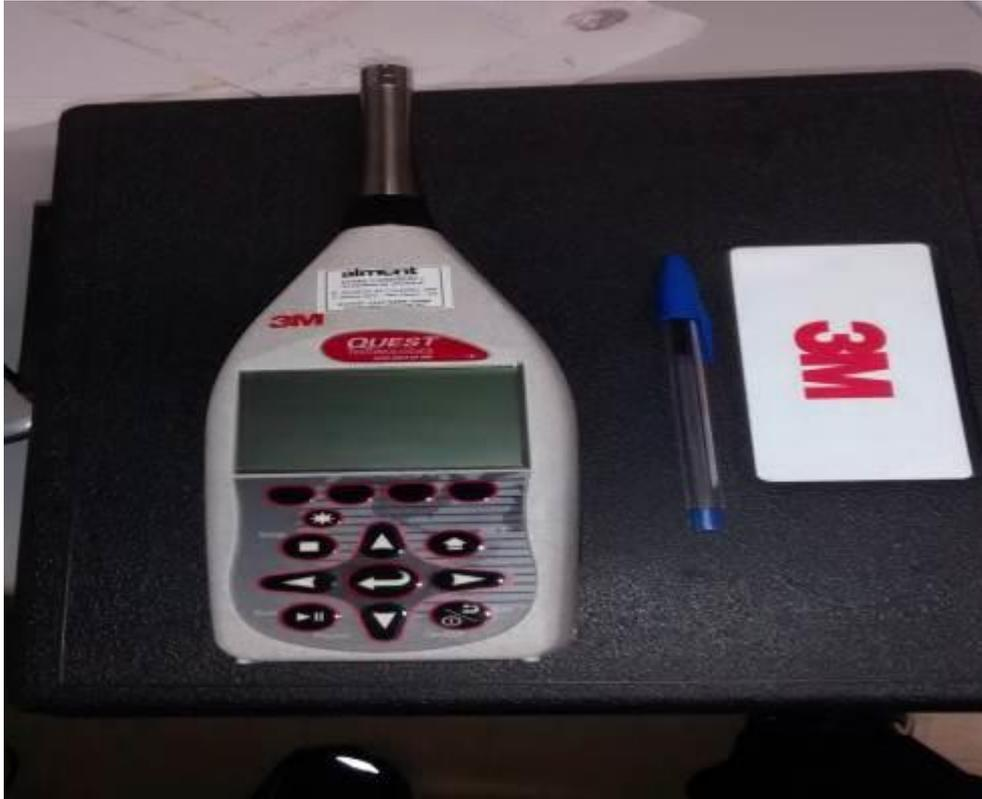
Figura 6 - Medidor de nível de pressão sonora.
