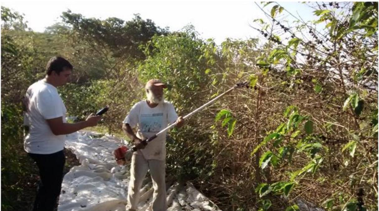
Figura 1- Derriçador manual
